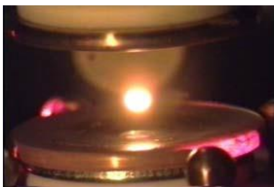
図1 地上静電浮遊炉での浮遊と加熱
