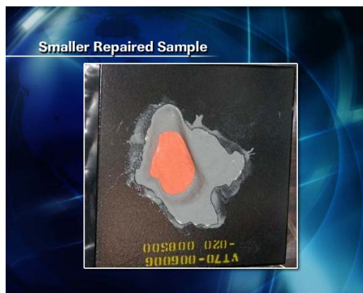
【参考】地上での T-RAD を使用し た修理後のタイル
