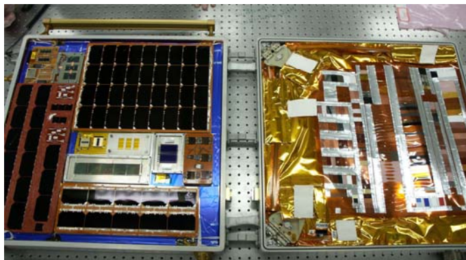
材料曝露実験装置 6 (Materials ISS Experiment: MISSE-6) エンデバー号のペイロードベイ (貨物室) に搭載された様子 (NASA ケネディ宇宙センター (KSC) オービタ整備棟)
