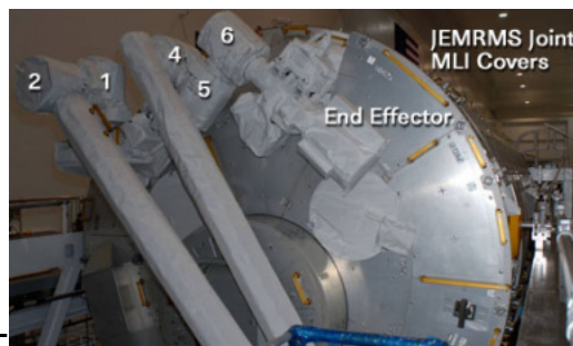
各関節の断熱カバー
