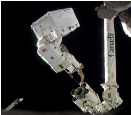
ISSのロボットアーム（SSRMS）に乗って、窒素タンク（NTA）を運ぶクルー（STS-122）
