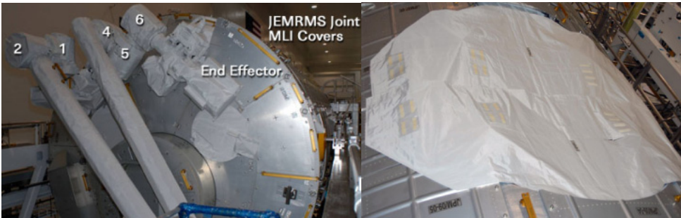
JEMRMSの断熱カバー(左)、共通結合機構の断熱カバー(右)
