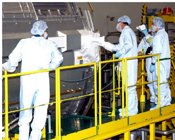
船内実験室のトラニオン／キールピンにカバーをつけるクルー （宇宙ステーション整備施設 KSC）
