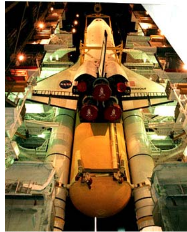
VAB 内で組み立てられるシャトル (左写真：オービタの吊り上げ、右写真：SRB/ETへのオービタの取り付け)
