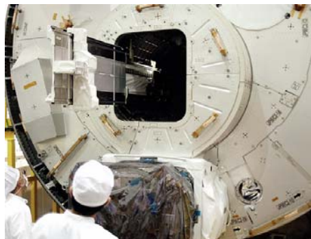
図3.2.3-3 船内実験室のエアロック【「きぼう」固有の機構】
