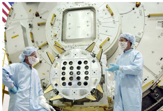
図3.2.3-6 船内実験室の左舷側エンドコーンの 船外実験プラットフォーム結合機構 【「きぼう」固有の機構】
