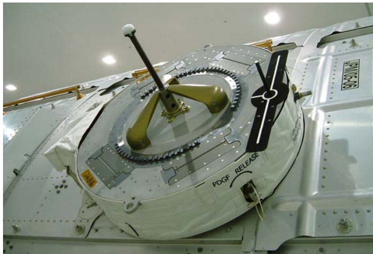
図3.2.3-5 船内実験室のPDGF【ISS共通の機構】
