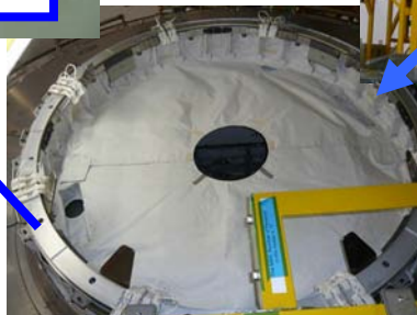
船内実験室のパッシブ共通結合機構（PCBM）と保護カバー
