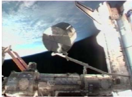
スペースシャトルのロボットアーム（SRMS）で船内保管室をペイロードベイ（貨物室）から取り出し、ハーモニーに取り付けているところ（STS-123）
