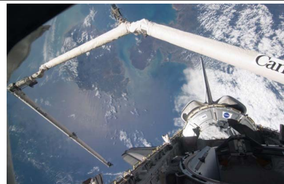
OBSSを使用した左翼前縁のTPS検査の様子 (STS-130)
