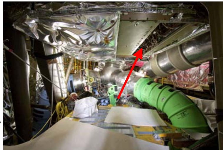
ALCA-2の位置(太い配管はメインエンジンへ推進薬を供給する配管) 本写真の上側が機首方向
