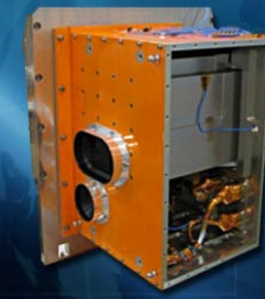
STORMM DTO用のターゲット(ISSのPMA-2に装備)と、シャトルに装備するセンサ(下)
