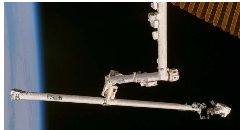
修理のためOBSSの先端を足場にして作業する様子(STS-120)
