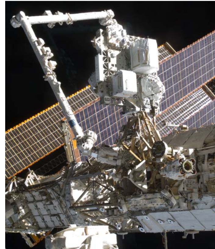
SSRMSでS3トラス上部にELC-2を設置する様子(STS-129)
