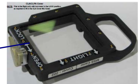
TVカメラのレンズの前に装着するカバー
