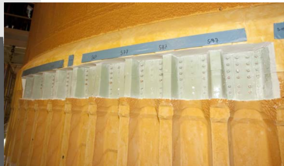
ストリンガーの上部を補強するため、断熱材を切除した状態
