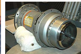
交換されたQD(配管接続部)
