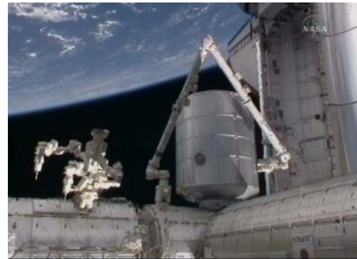
MPLM「レオナルド」(中央のモジュール)のノード2 「ハーモニー」下部への設置(STS-131)
