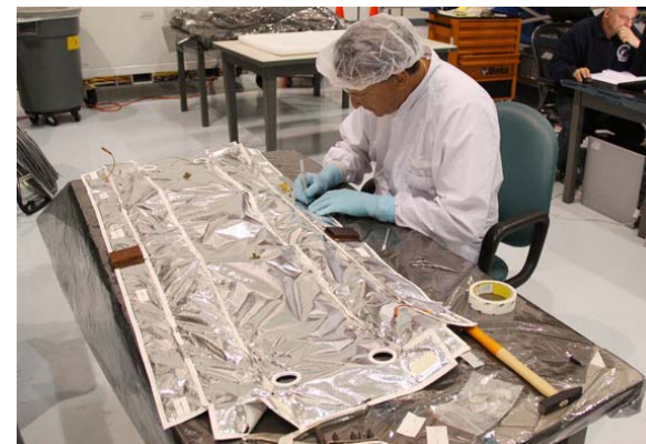
ケブラー等の素材で作られ たこの銀色のシートを与圧 壁と外側のパネルの間に 追加
