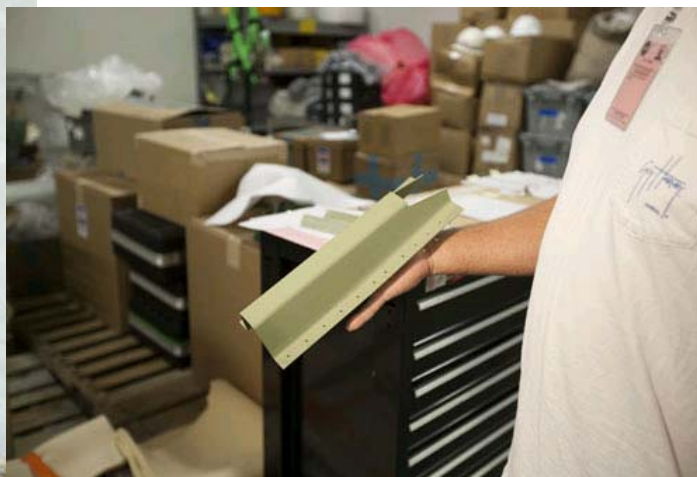
クラックが見つかったストリンガーの修理に使われたダブラー
