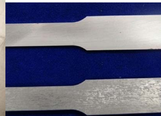
異常が見つかった材料(下側が表面に斑点が生じた材料)
