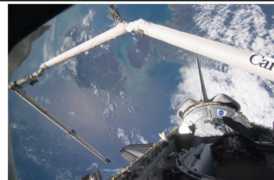
OBSSを使用した左翼前縁のTPS検査の様子 (STS-130)
