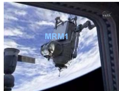
キューポラの窓から見た MRM1移送(イメージ)
