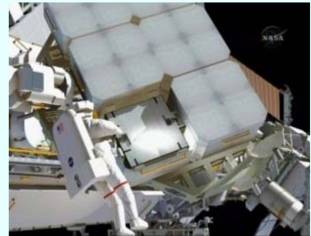
EVAクルーが、ICC-VLDに搭載されているバッテリーORUの断熱カバーを外して、固定ボルトをゆるめているイメージ
