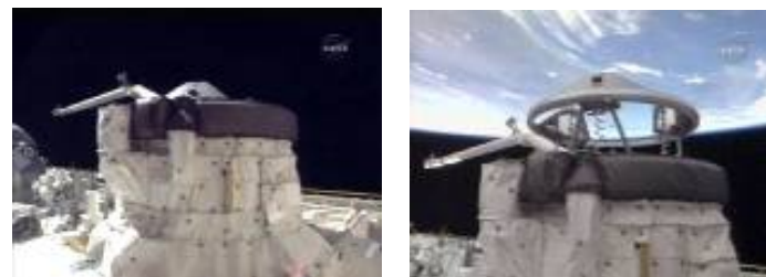
スペースシャトルのODSドッキングリングの伸展(STS-123)
