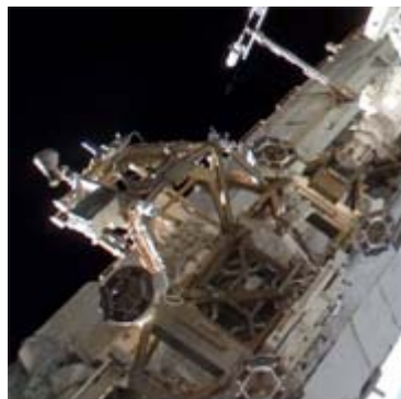
ICC-VLDの設置場所となるモバイル・ベース・システム (MBS) (STS-123)
