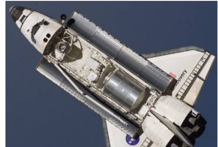
RPM時にISSから撮影したペイロードベイ(貨物室) MPLMが搭載されている(STS-121)
