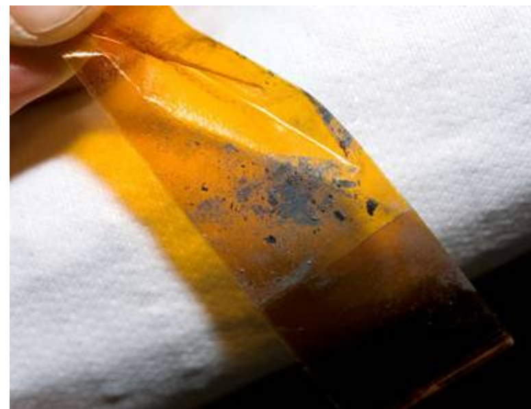
右舷側SARJの不具合の原因調査のために、EVAで採取した金属粉(STS-120)
