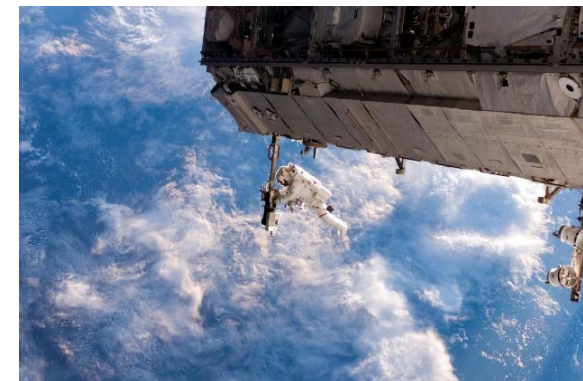
ETVCGの取付け(STS-116:S1トラス)
