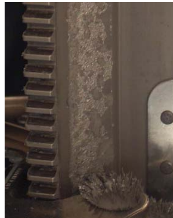
SARJ表面の損傷状況
