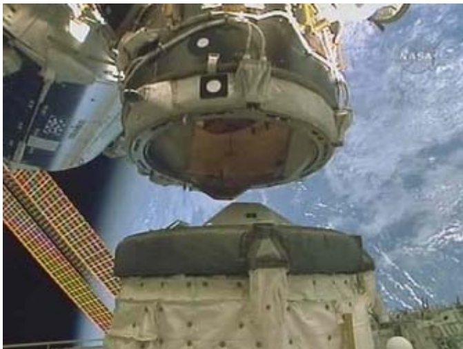
ISSからの分離 (上はISSのPMA-2、 下はスペースシャトルのODS)
