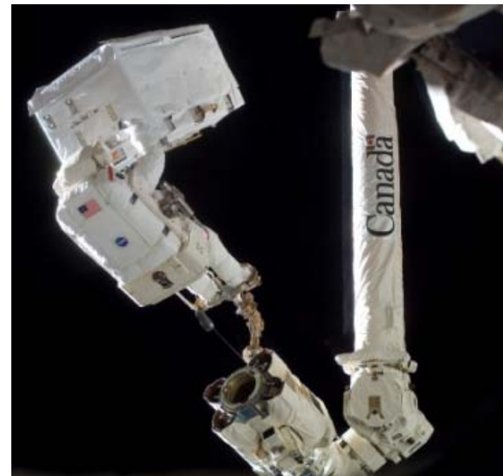
船外活動によるNTAの交換作業(STS-122)
