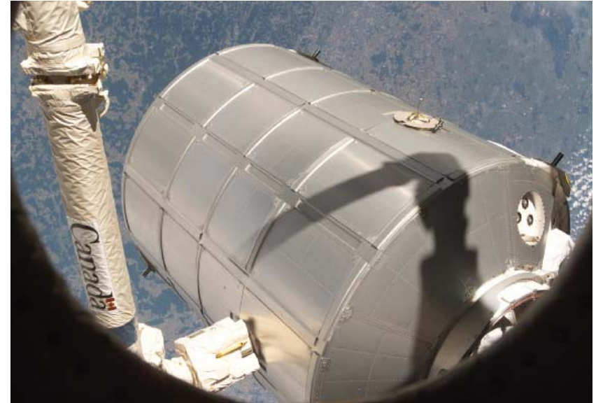
SSRMSで MPLMをスペースシャトルのペイロードベイ(貨物室)に回収するためにMPLMのグラブル・フィクスチャを把持したところ(STS-121)
