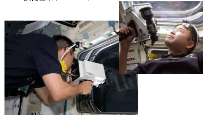
ISSとのランデブ時に、スペースシャトルの窓からISSとの距離を測定(STS-124)
