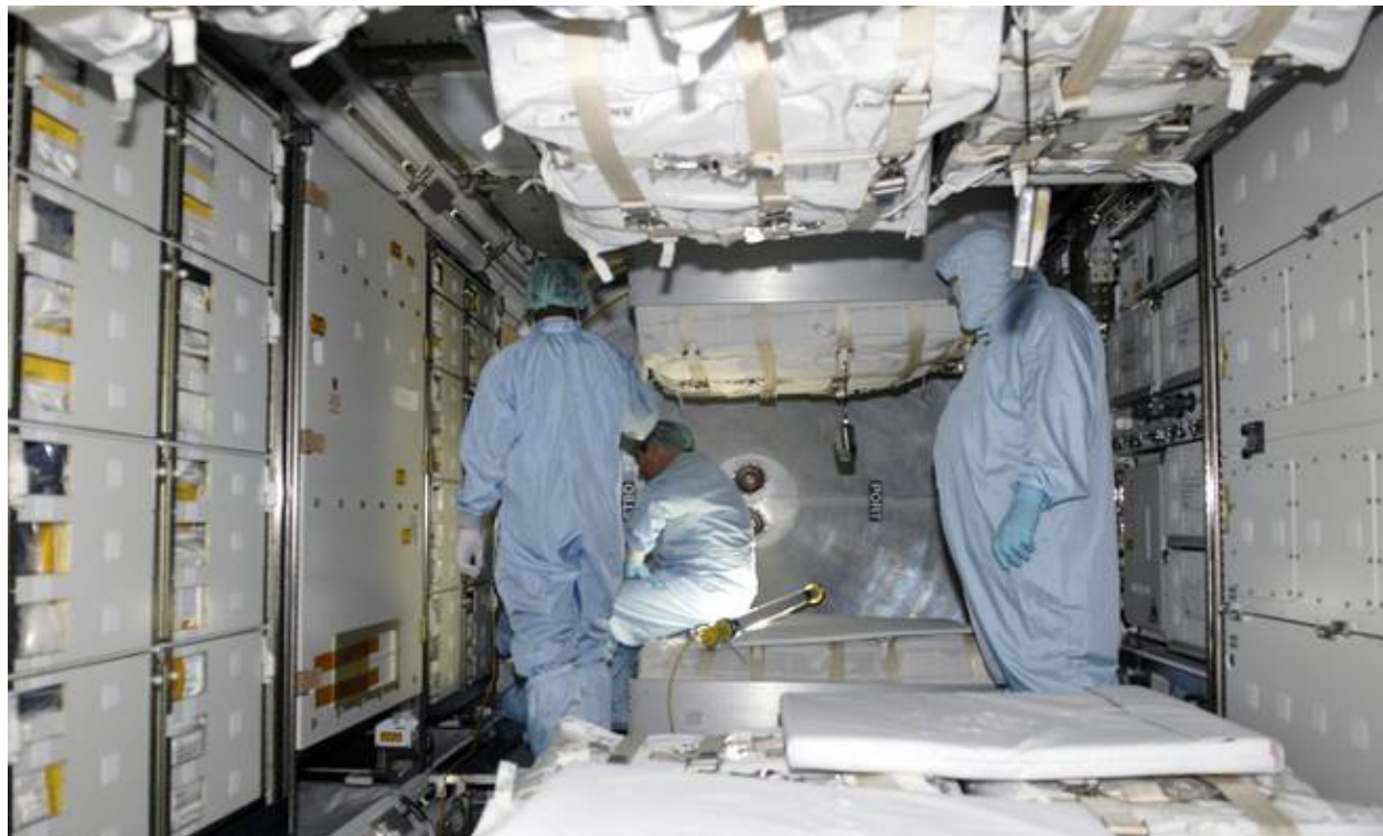
MPLM内部:ISSに運搬する装置類、ラック類を搭載している(打上げ前) (KSC宇宙ステーション整備施設(SSPF))
