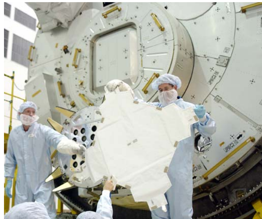
EFBMのMLIカバー(KSC SSPF)
