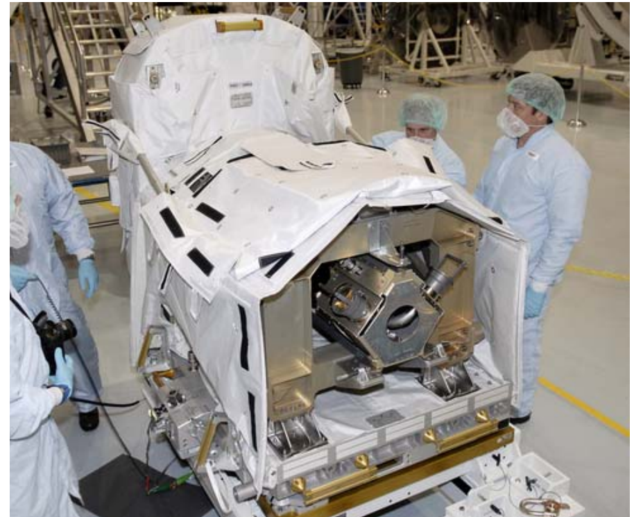
フレックス・ホース・ロータリ・カプラ (Flex Hose Rotary Coupler: FHRC) (KSC SSPF)
