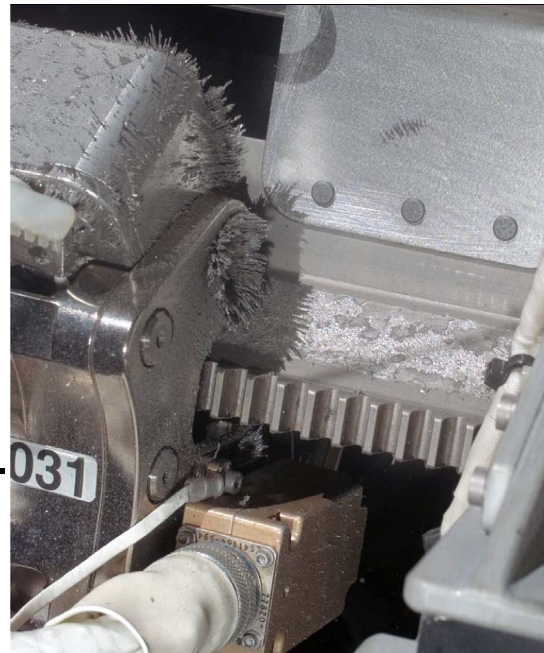
SARJのTBA周辺に付着した金属粉 (NASA STS-126プレスキット)
