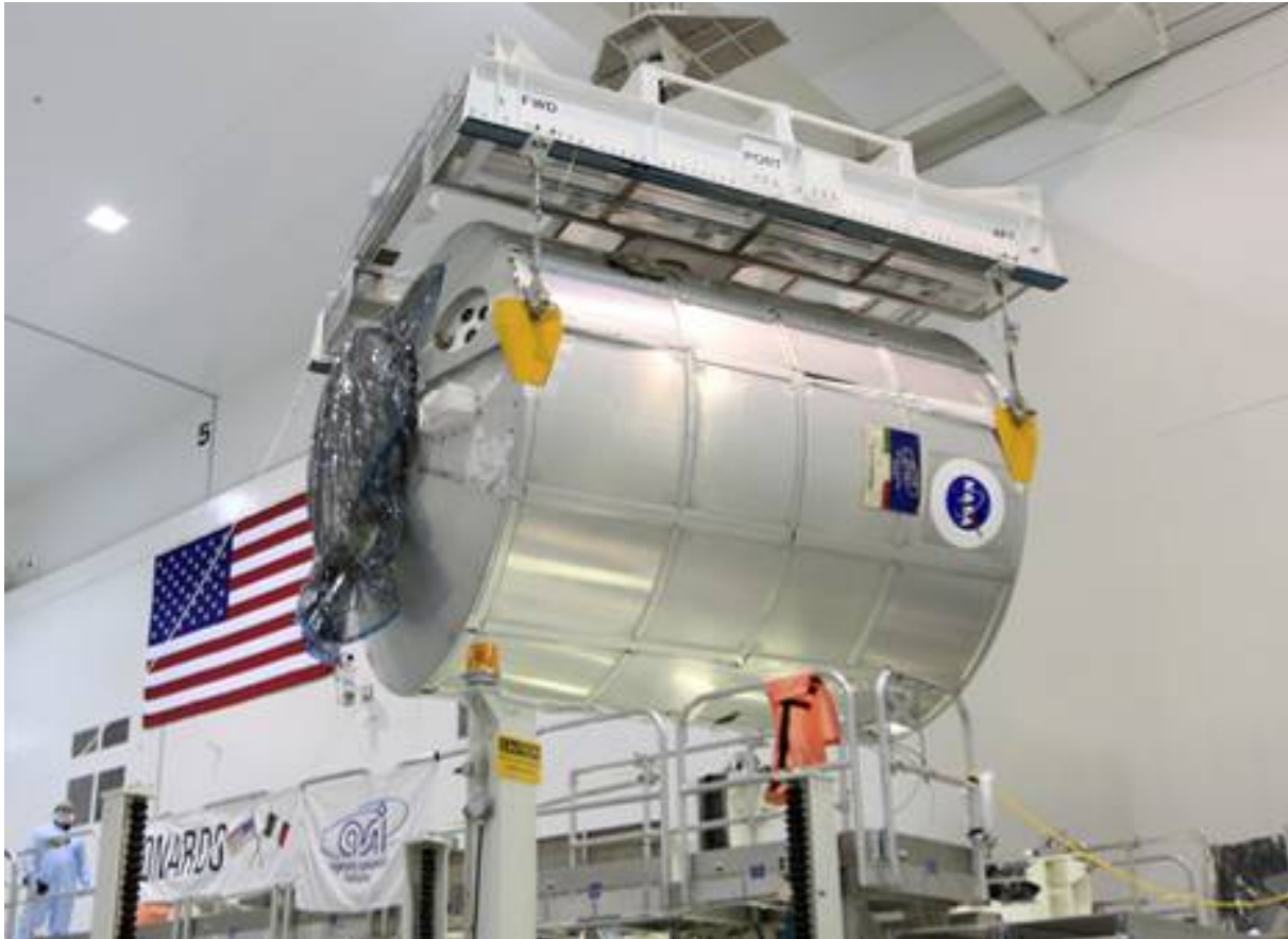
MPLM(NASAケネディ宇宙センター(KSC)宇宙ステーション整備施設(SSPF) )
