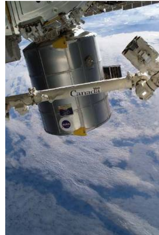
ISSのユニティ(Node1)下側に取り付けられているMPLM(STS-114)
