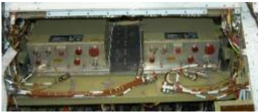
カーゴベイの下に新たに装備された2基の電力供給ユニット(Power Transfer Unit: PTU)
