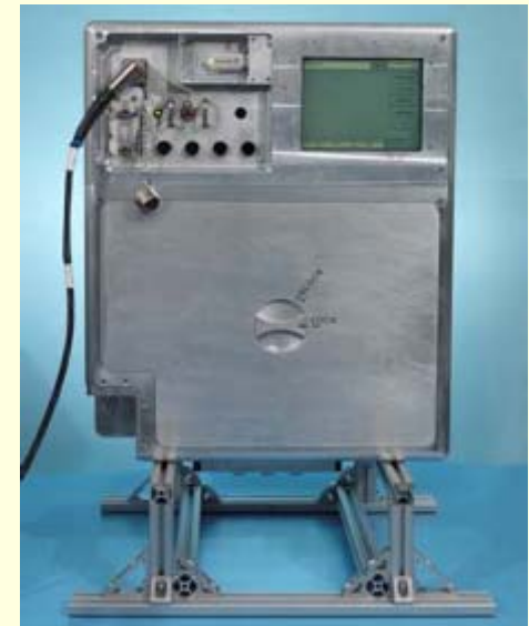
有機炭素分析器(Total Organic Carbon Analyzer: TOCA II) (NASA STS-126プレスキット)
