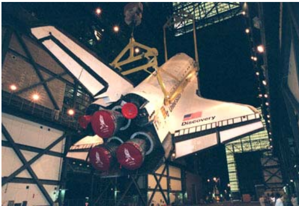
図-6 VAB 内で組み立てられるシャトル (左写真：オービタの吊り上げ、右写真：SRB/ET へのオービタの取り付け) (NASA HP より)
