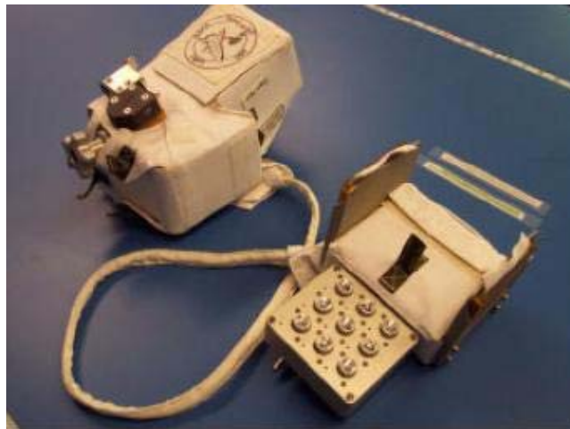
図1.3.3-2 赤外線ビデオカメラ（エンジニアリングモデル） （NASA STS-121Press Kit 2006/06/06版より）
