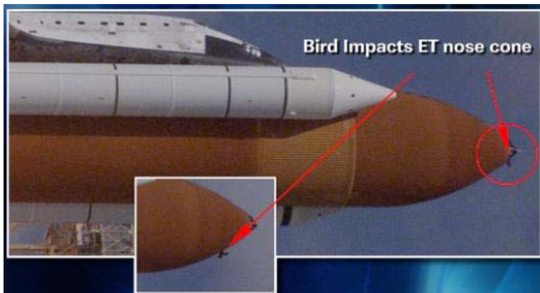
図 3.4-5 ET に鳥が衝突した映像 (NASA HP より)
