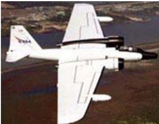
撮影用の WB-57 航空機と搭載されたビデオカメラシステム (4,150mm の反射望遠鏡)
