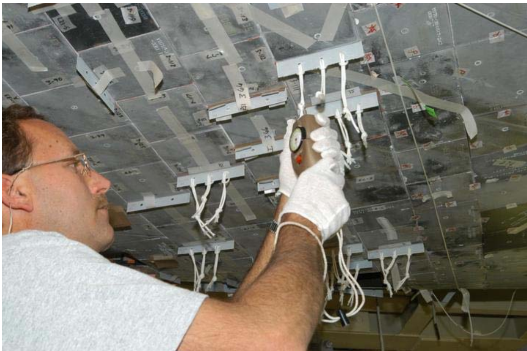
図 3.4-3 新しいギャップフィラーの取付とその引張試験の様子 (NASA HP より)
