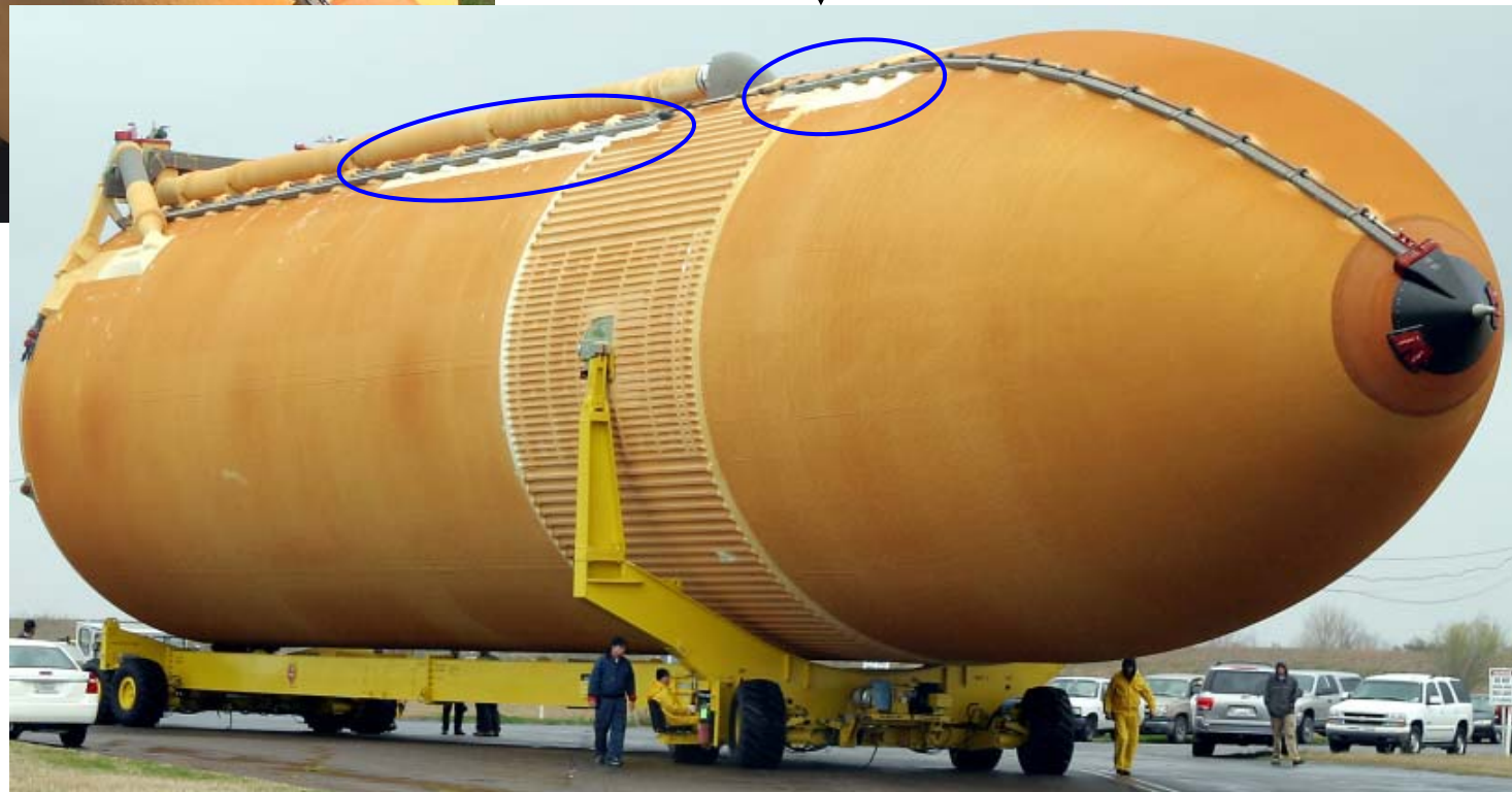
図4 STS-114前後で改良されたETの写真 (写真:Lockheed Martin社HPより)
