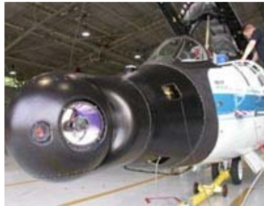
撮影用の WB-57 航空機と搭載されたビデオカメラシステム (4,150mm の反射望遠鏡)
