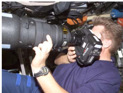
写真右：ISSで使われているデジタルカメラと800mm望遠レンズ (400mmレンズ+テレコンバータ)
