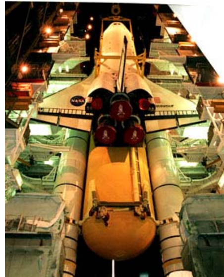
図-6 VAB 内で組み立てられるシャトル (左写真：オービタの吊り上げ、右写真：SRB/ET へのオービタの取り付け) (NASA HP より)
