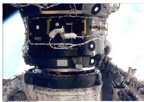
写真右：ドッキング後にODSの伸展リングを引き込む状況(上半分がPMA-2)
