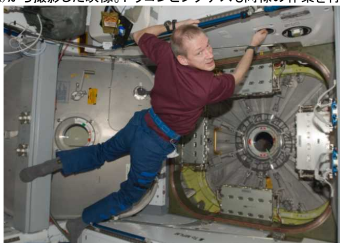
図4.3-7 共通結合機構(CBM)の2枚のハッチ(ISS側のハッチを開けた状態)
