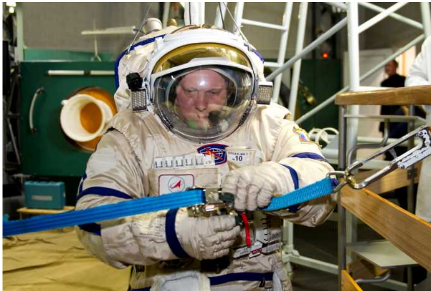
図 5.2-4 帰還直後に火星の重力を模擬して船外活動を試験する様子 (GCTC)
