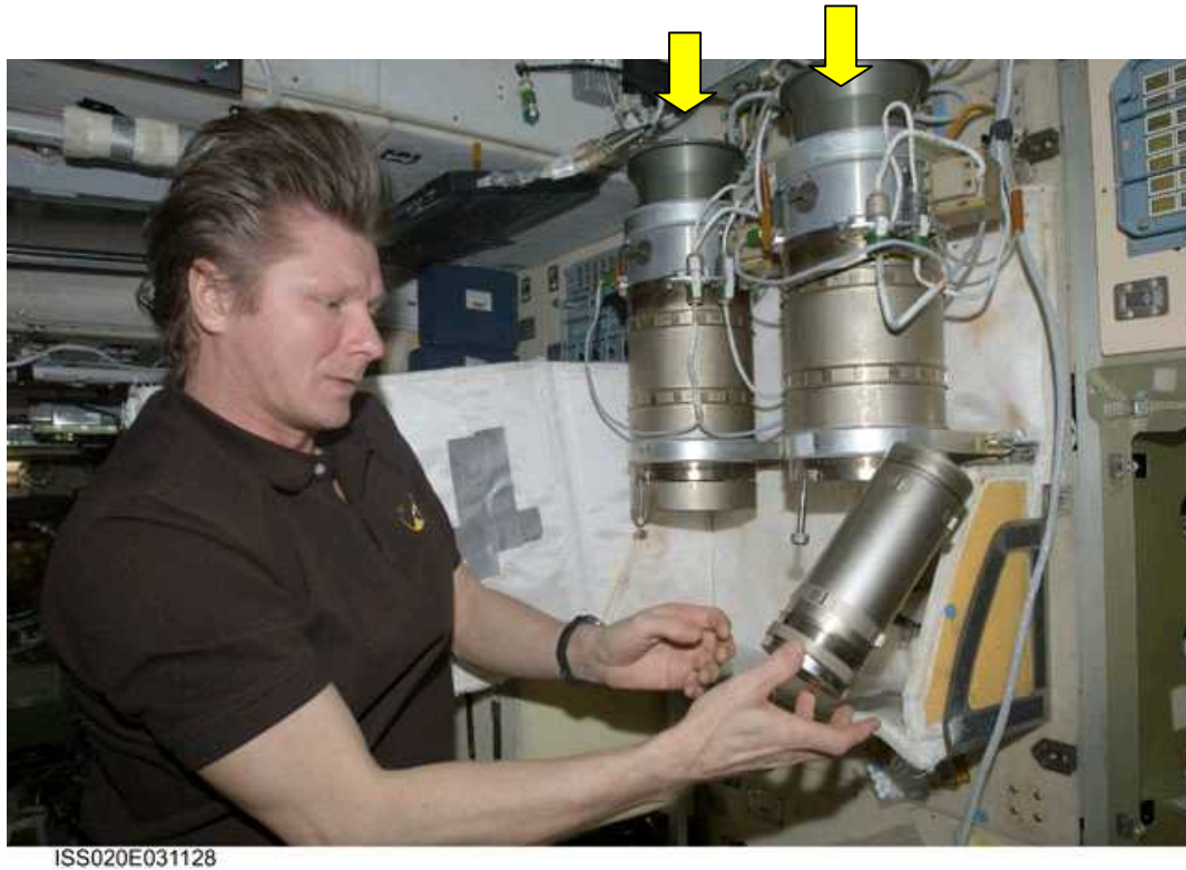
図4.2-2 ズヴェズダ内に設置されているSFOG容器2本(矢印)
