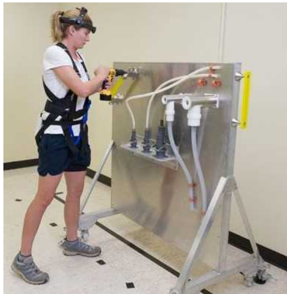
図5.2-6 組み立て能力を確認する試験の例(NASA)
