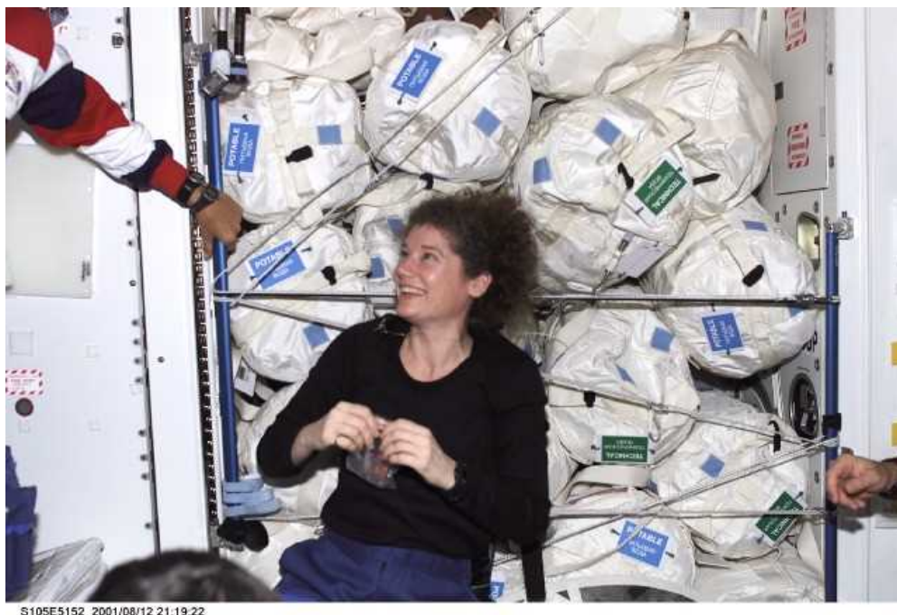
図4.1-6 米国の水容器(CWC) (表面が布地のソフトタイプの容器)
