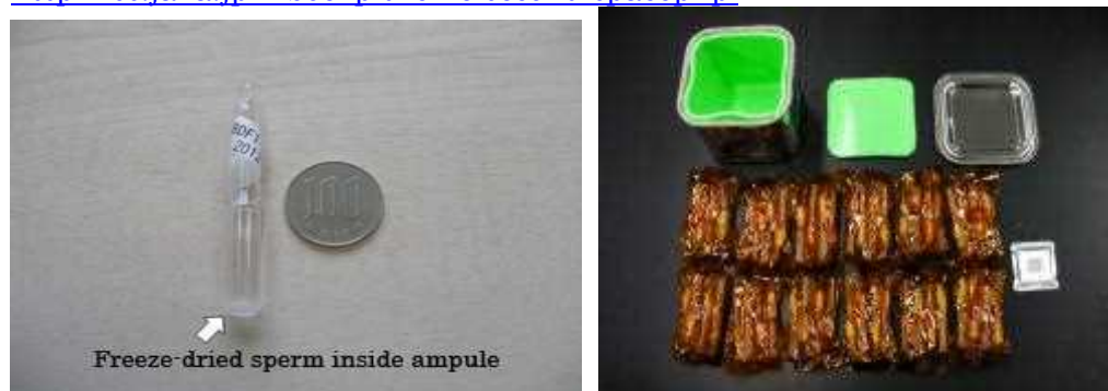
図4.1.1-7 宇宙実験でマウスの精子を保存するのに使用するアンプル。アンプルは右の写真のようにカプトンテープで保護してケースに収納します。(「こうのとりの4号機」で運搬) (JAXA)
