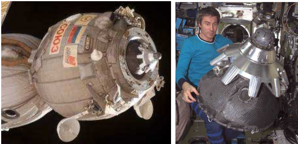
図2.5-1 ソユーズ宇宙船のドッキング機構
