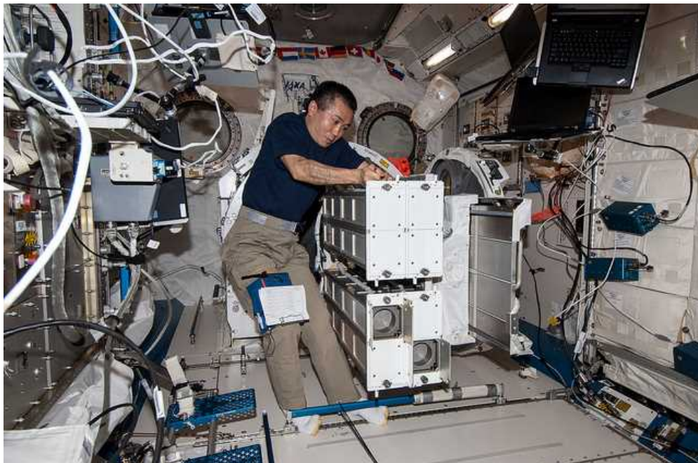
図 4.1.1-24 NanoRacks 社の CubeSat 放出機構を設置する若田宇宙飛行士 これを使えば、3U サイズの CubeSat が 16 機放出できます。
