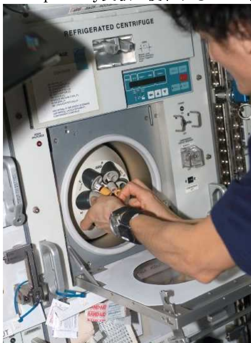
図4.1.2-2 医学試料を扱えるISSの冷蔵遠心分離器（NASA）
