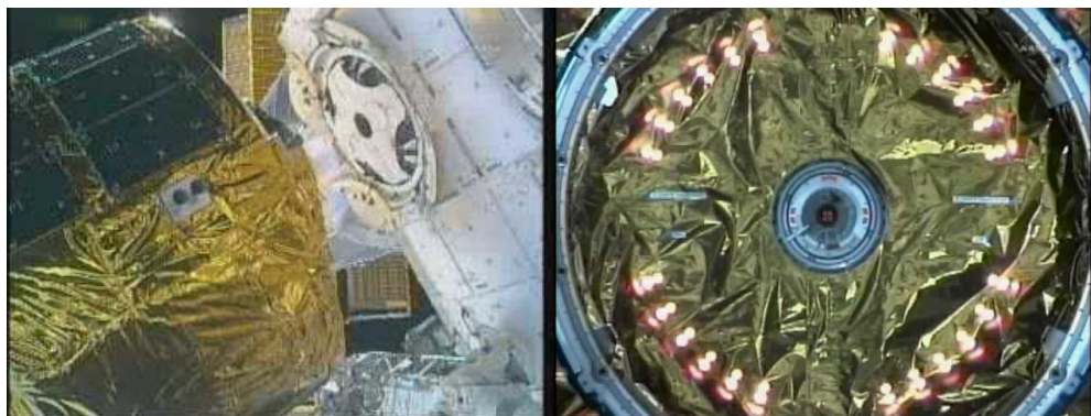
図4.3-6 「こうのとりのこり」到着時の共通結合機構の位置調整作業 (右は、ハーモニーの窓に位置決め用に設置するCBCS (Centerline Berthing Camera System)から撮影した映像。ドラゴンとシグナスも同様の作業を行います。)
