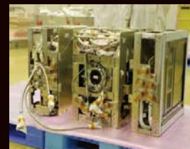
「きぼう」に送られる前の静電浮遊炉
