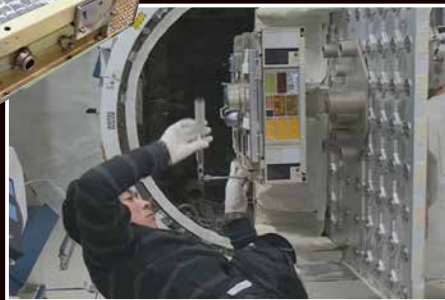
「きぼう」のエアロックスライドテーブルにExHAM2号機を取り付け、船外へ搬出する準備を行う油井宇宙飛行士
