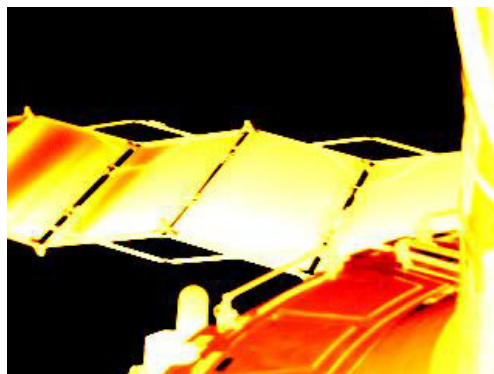
赤外線ビデオカメラ（左）で撮影したラジエータの熱分布映像（右：STS-121）
