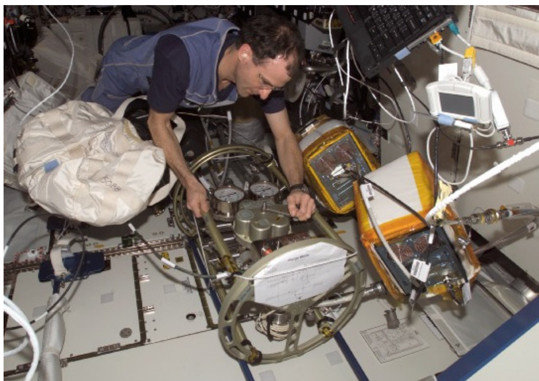
図4.3.4-8 デスティニー内での熱制御系流体の補充作業
