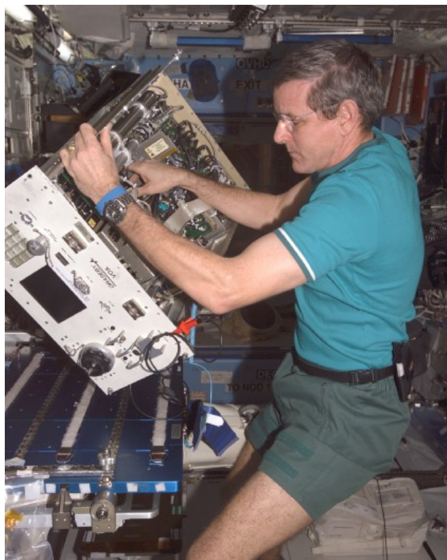
図4.3.4-7 故障した装置(揮発性有機物分析器(VOA))の修理
