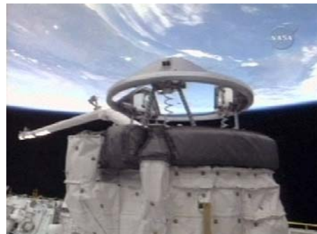
オービタ・ドッキング・システム（ODS）リングの展開の様子
