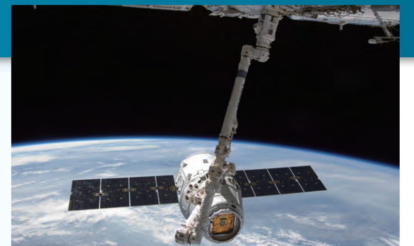
ロボットアームで把持されたドラゴン補給船
