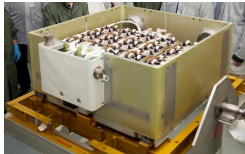
ISSに搭載するバッテリーの組立て、中に入っているのは日本製のリチウムイオン電池(米ボーイング社)
