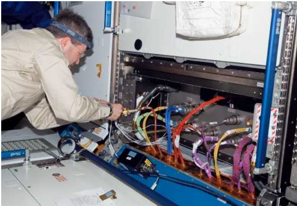
図3.4-4 ハーモニーの電力・通信配線のトラブルシューティング(NASA)(故障箇所の究明)
