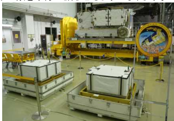
図1.2-6 HTV6で運ぶ新型バッテリー(手前)とそれを搭載した曝露パレット(後方) (JAXA)
