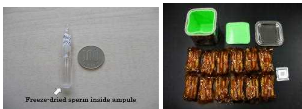
図4.1.1-4 宇宙実験でマウスの精子を保存するのに使用するアンプル。アンプルは右の写真のようにカプトンテープで保護してケースに収納します。( 「こうのとりの」 4号機で運搬) (JAXA)
