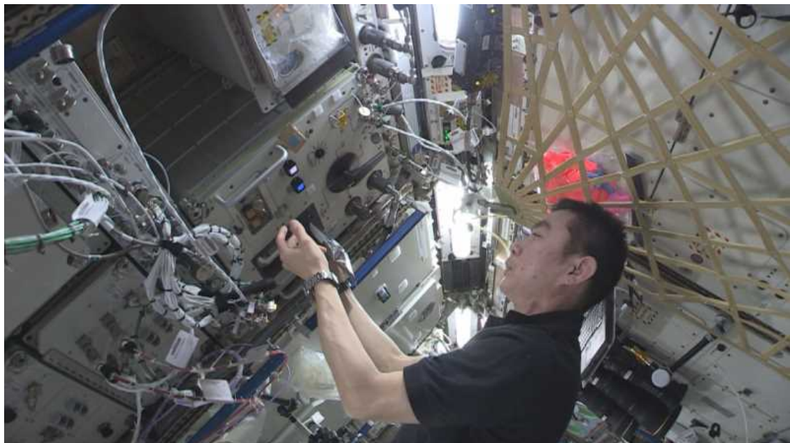
図3.2-4 飲料水供給装置を使う野口/油井宇宙飛行士（JAXA） （上はロシアの機器、下は米国の機器）
