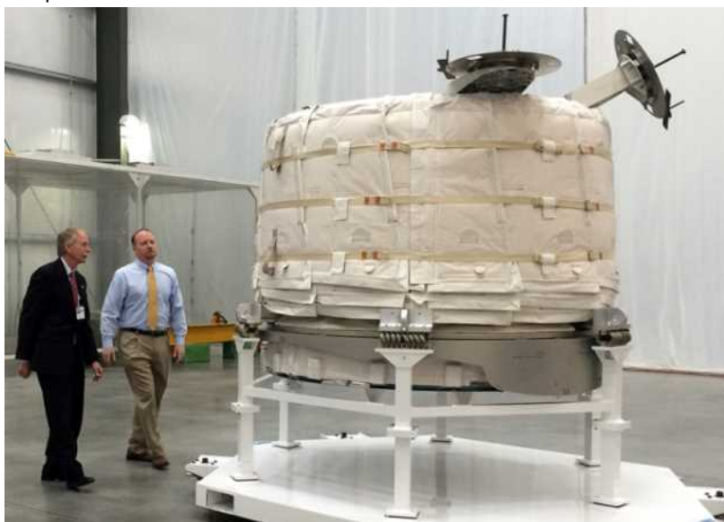
図6 2015年3月12日に初公開されたBEAMの実機(打上げ時の収納状態)(NASA)
