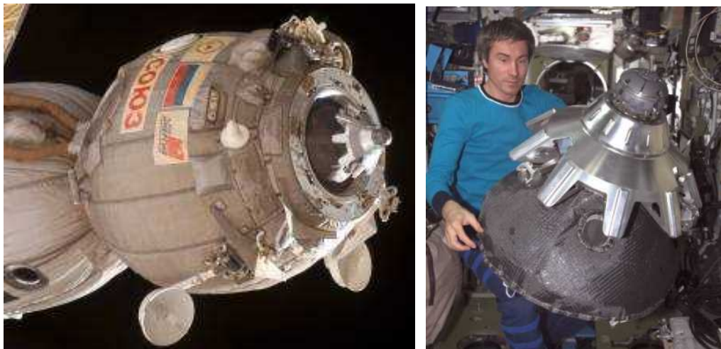
図2.5-1 ソユーズ宇宙船のドッキング機構
