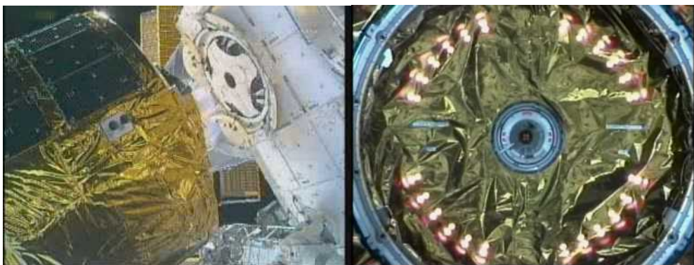
図4.3-6 「こうのとりのとり」到着時の共通結合機構の位置調整作業 (右は、ハーモニーの窓に位置決め用に設置するCBCS (Centerline Berthing Camera System)から撮影した映像。ドラゴンとシグナスも同様の作業を行います。)
