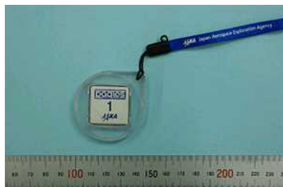
図4.1.1-19 JAXAが開発したCrewPADLES(受動式線量計) これを常に携帯します
