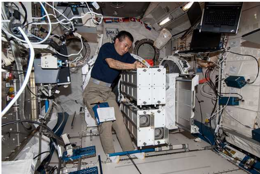
図 4.1.1-26 NanoRacks 社の CubeSat 放出機構を設置する若田宇宙飛行士 これを使えば、3U サイズの CubeSat が 16 機(48U に対応)放出できます。
