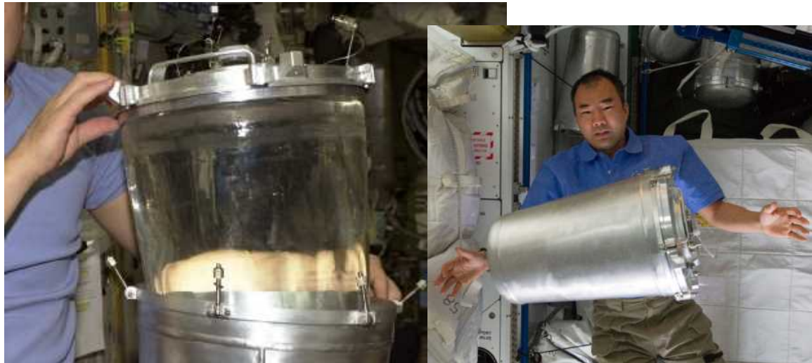
図4.1-5 ロシアの水容器(EDVタンク) (NASA) (ビニールのような容器を金属容器で囲ったもの)
