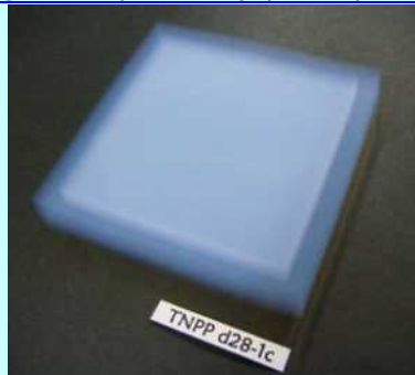
図4.1.1-30 千葉大学が開発した「たんぽぽ計画」用の低密度エアロゲル (千葉大)
