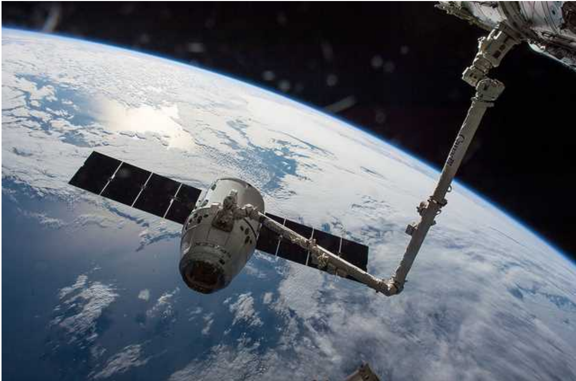
図4.3-2 ロボットアームで把持されたSpace X社のドラゴン補給船(SpX-8)(NASA) https://www.flickr.com/photos/nasa2explore/26298228022/
