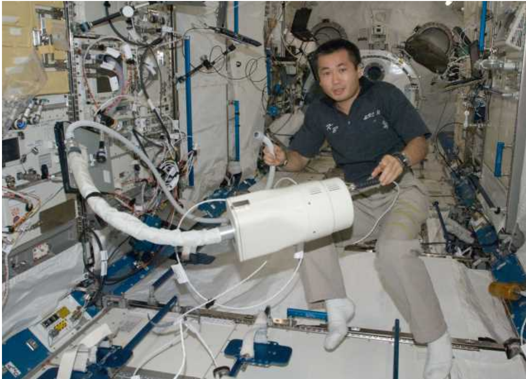
図4.2-3 「きぼう」の船内で掃除機をかける若田宇宙飛行士(中央の白い円筒が掃除機本体、 右手に持っているのが吸い込みノズル)
