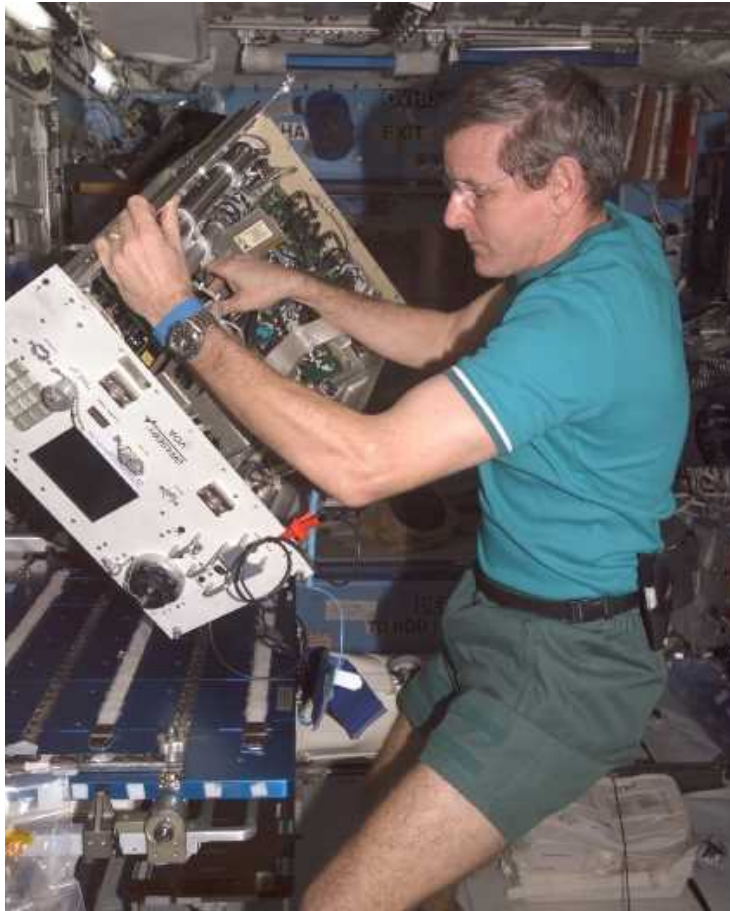
図3.4-3 故障した装置(揮発性有機物分析器(VOA))の修理(NASA)
