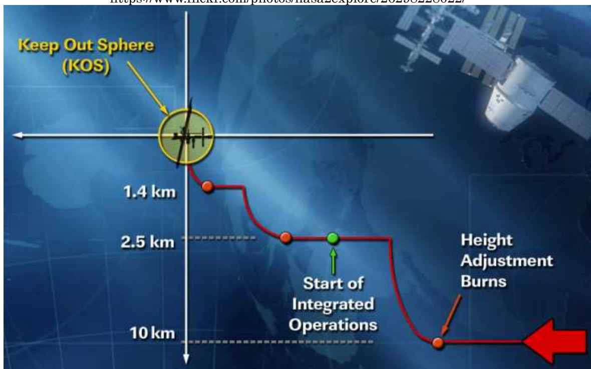
図4.3-3 ドラゴン補給船がISSに接近する方法 (Space X社)
