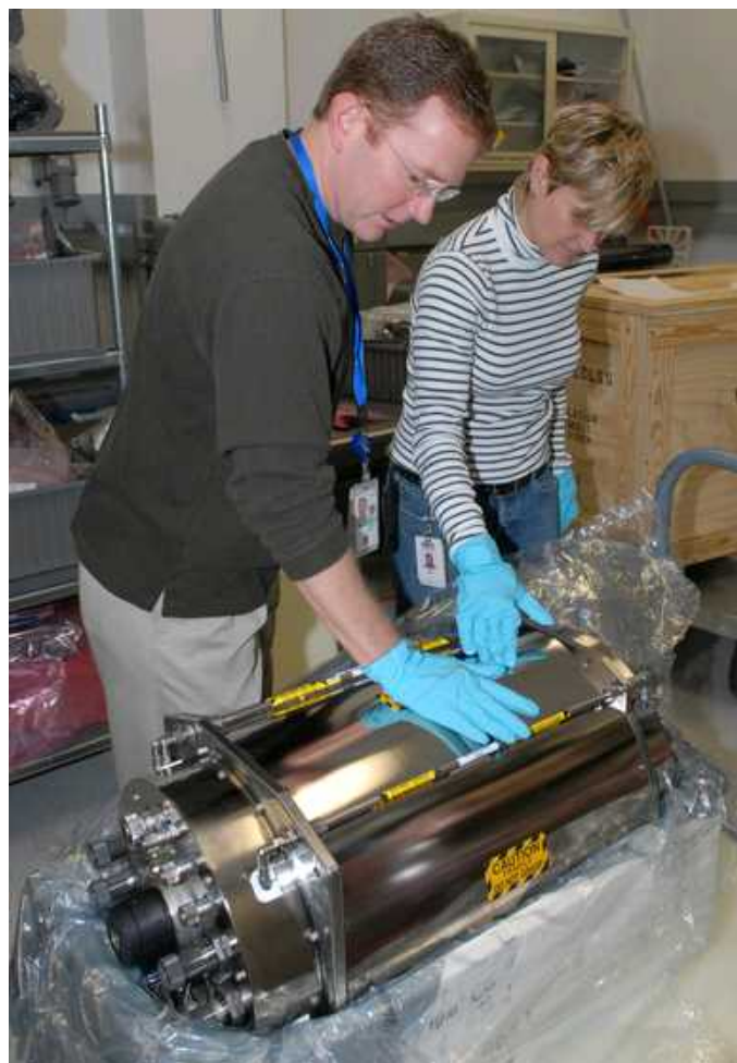
図4.1-4 STS-119で運ばれた交換用のDistillation Assembly (DA) (NASA KSC)
