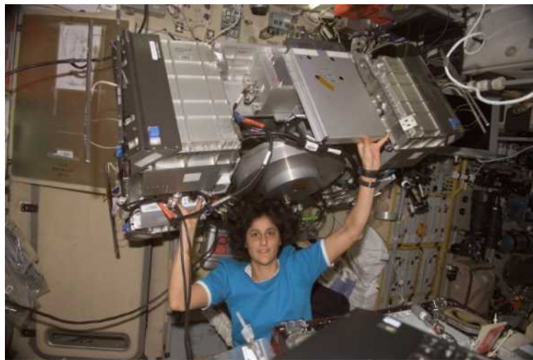
図3.4-1 TVISの修理(床下の機器を取り出した状態:2007年2月)(NASA) http://spaceflight.nasa.gov/gallery/images/station/crew-14/html/iss014e15350.html
