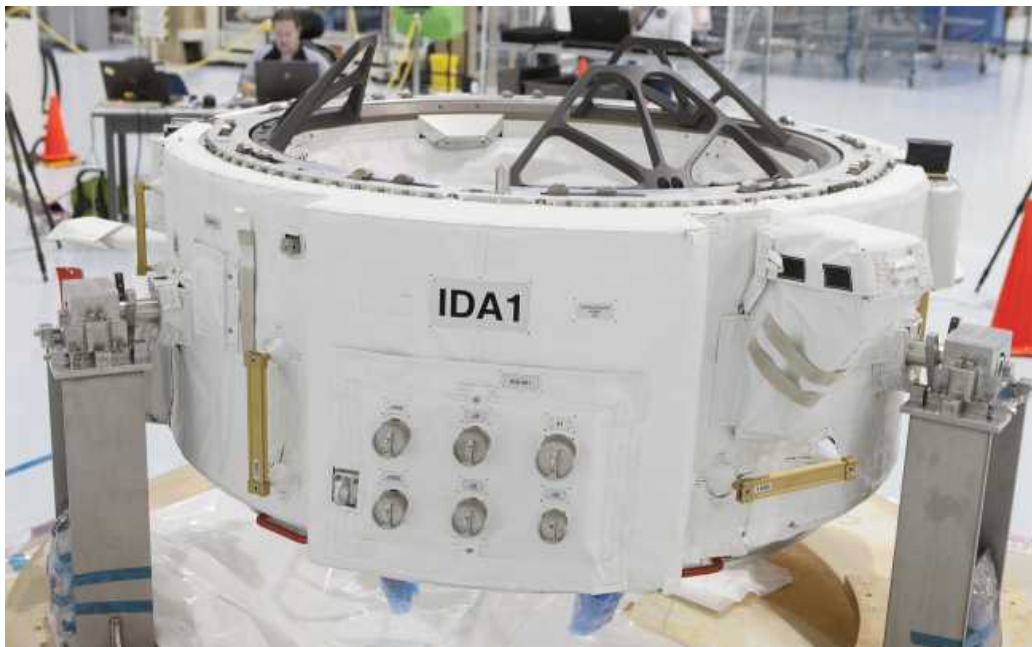
図5 SpX-7で運搬するために準備された国際ドッキングアダプター1(IDA1) (NASA/Cory Huston)
