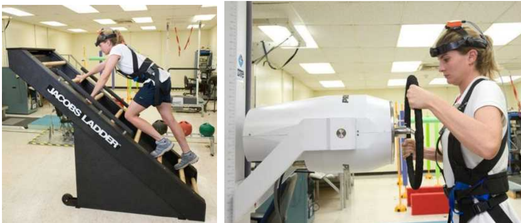
図4.1.2-13 梯子の昇降能力を試す試験、トルクをかけて回転させる試験の例(NASA)
