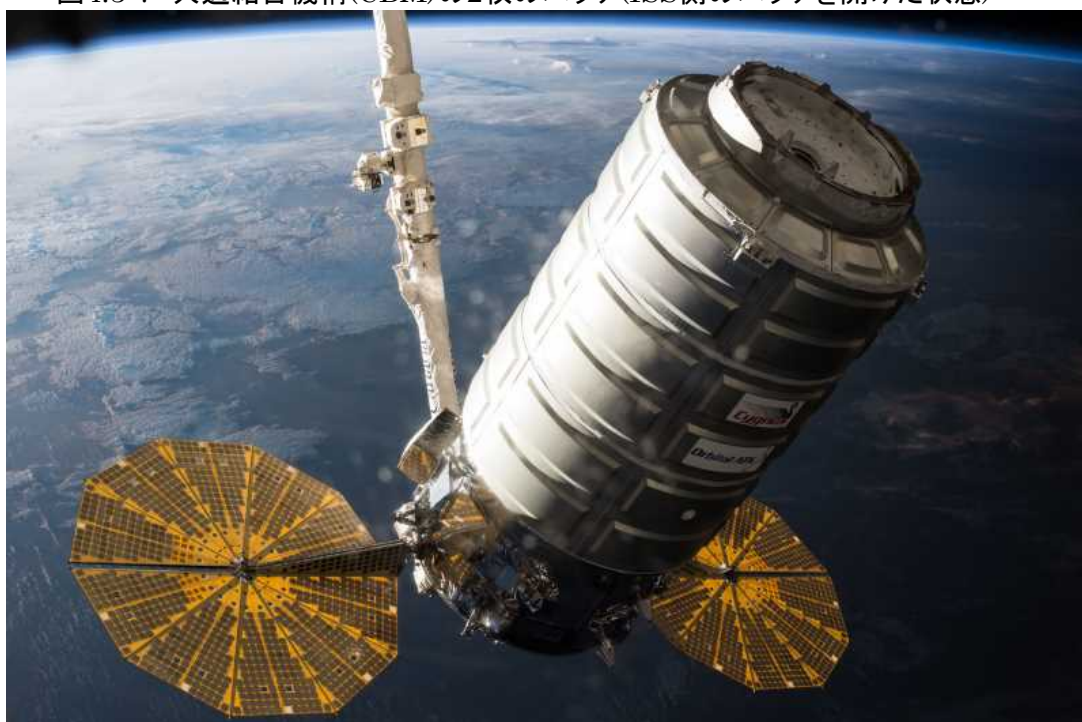
図4.3-8 ロボットアームで把持されたシグナス補給船(OA-6)(NASA)
