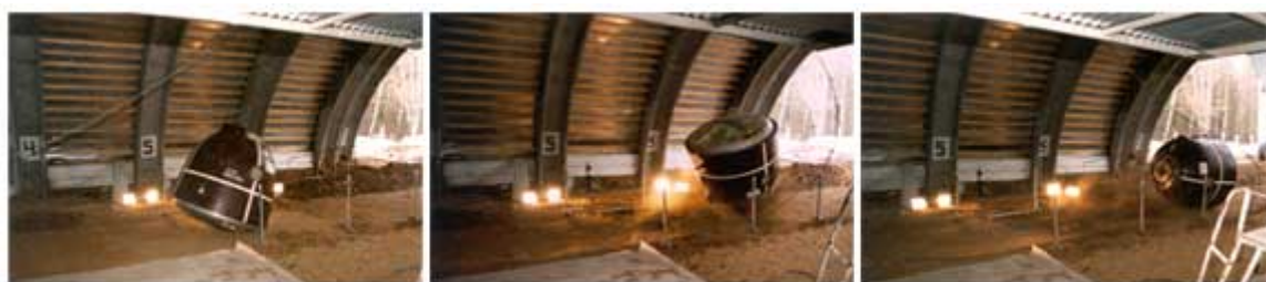
図2.1.5-1 ソユーズTMA帰還モジュールのモックアップの着地試験の様子
