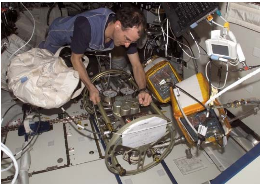
図3.3.4-8 デスティニー内での熱制御系流体の補充作業
