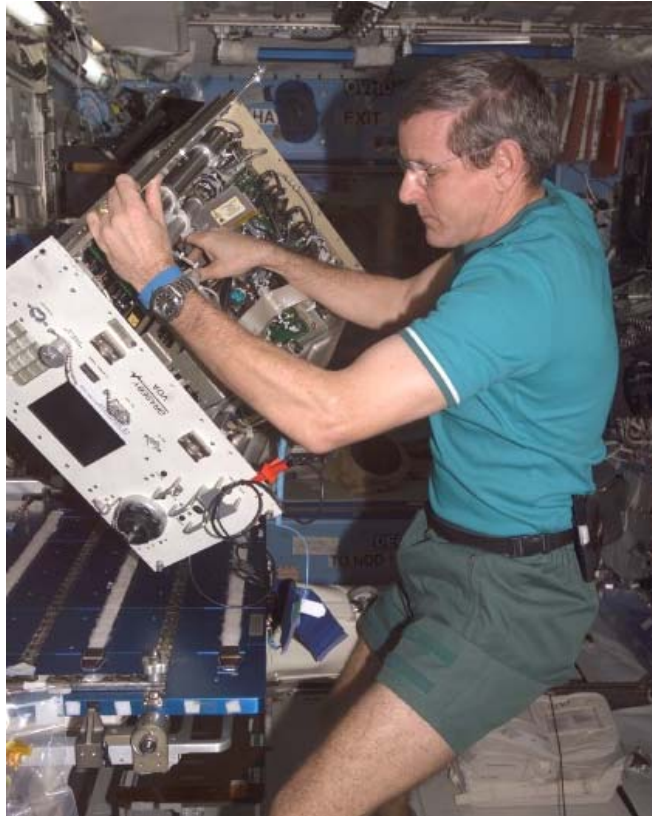
図3.3.4-7 故障した装置(揮発性有機物分析器(VOA))の修理
