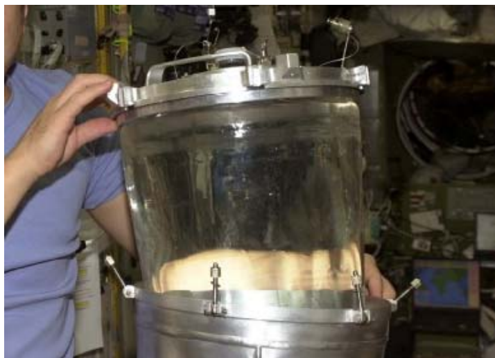
図3.4.1-5 ロシアの水容器(EDVタンク) (ビニールのような容器を金属容器で囲ったもの)
