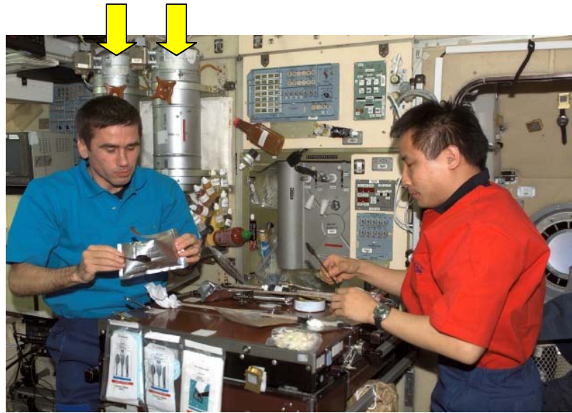
図3.4.2-2 ズヴェズダ内に設置されているSFOG容器2本（矢印）
