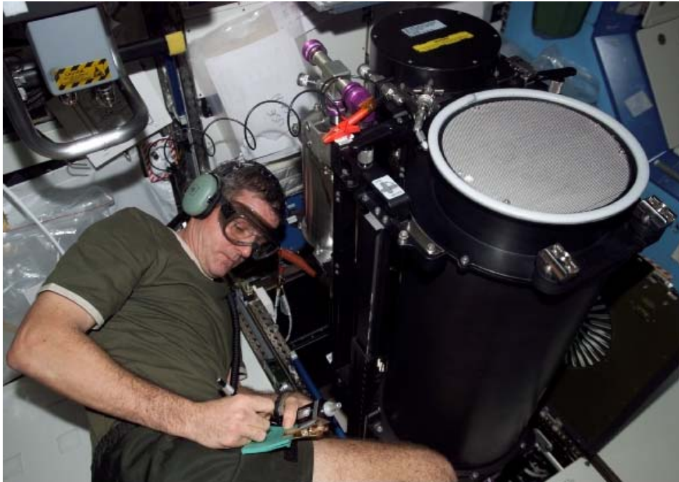
図3.3.4-5 米国の有害ガス除去装置(TCCS)の修理 (デスティニー内)
