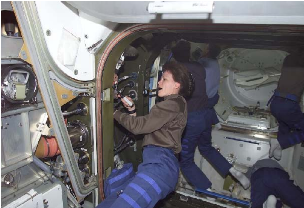
図3.3.4-9 米国のモジュール間での電力・通信・流体配管の接続作業
