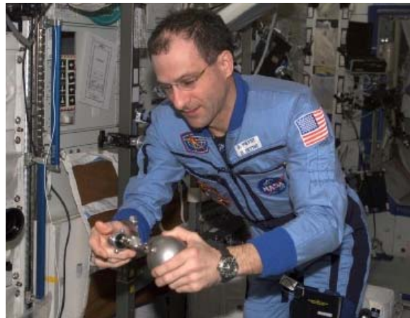
図3.3.3-7 ISS内での空気サンプルの採取作業(回収して地上で分析)
