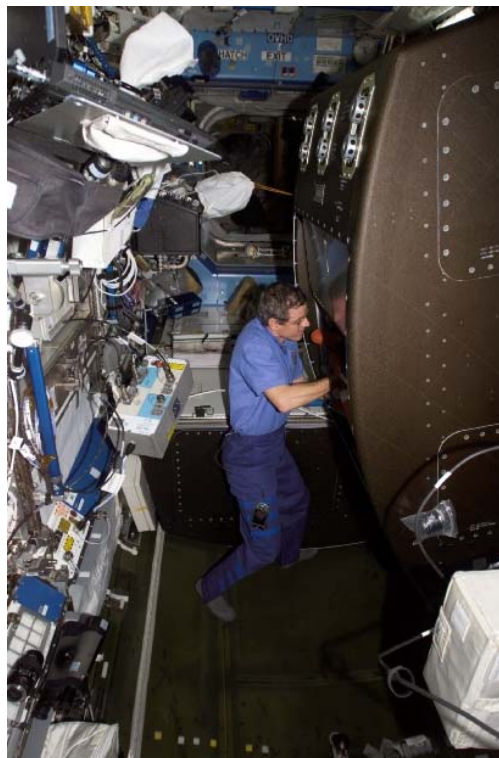
図3.3.4-15 ラック背面からアクセスする機器修理・調整作業
