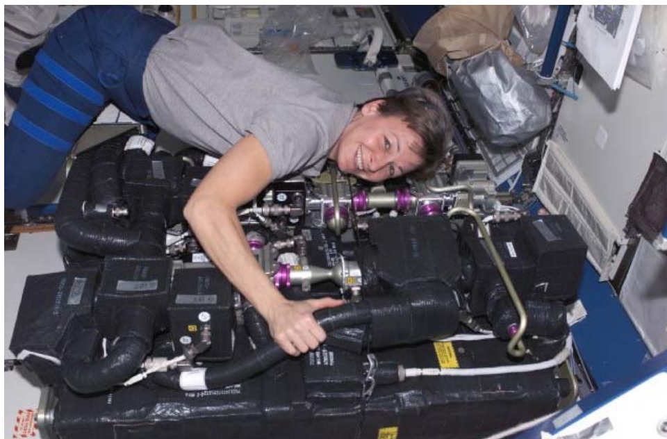
図3.4.2-4 米国の二酸化炭素除去装置(CDRA) (修理時の写真)
