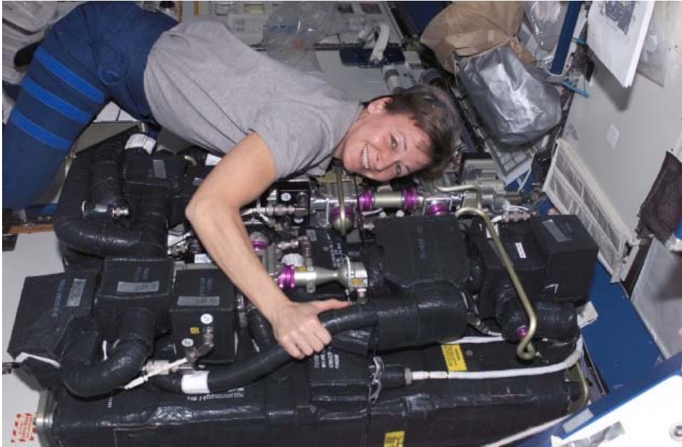
図3.3.4-3 米国の二酸化炭素除去装置(CDRA)の修理 (デスティニー内)
