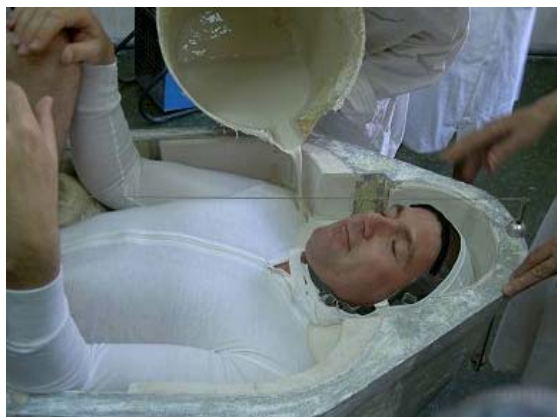
図2.1.6-8 シートライナーを石膏で型とりする様子
