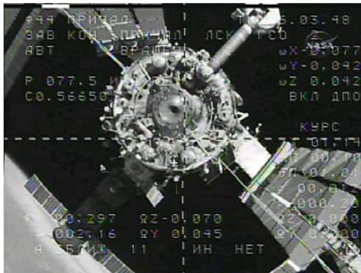
図2.1.6-1 ドッキング時の映像(カメラ映像にKursからのデータを重ねて表示) (速度、接近距離、姿勢の変化、時刻などを表示。中心線がドッキングポートの中心からずれるのは、そこにドッキングターゲットがあるためであり正常)
