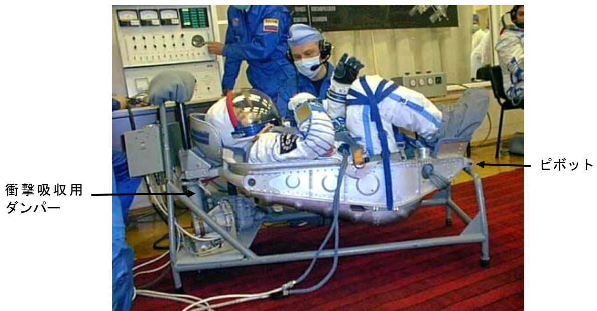
図2.1.6-7 ソユーズ宇宙船の座席シートと搭乗姿勢 (RSCエネルギーHP)
