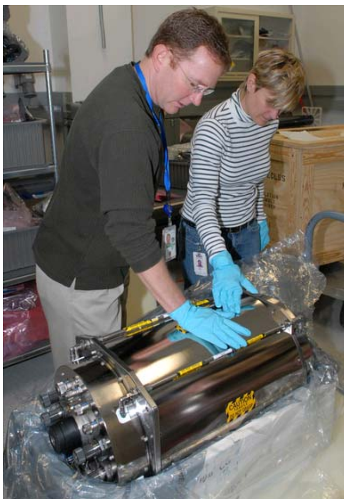
図3.4.1-4 STS-119で運ばれる交換用のDistillation Assembly(DA)
