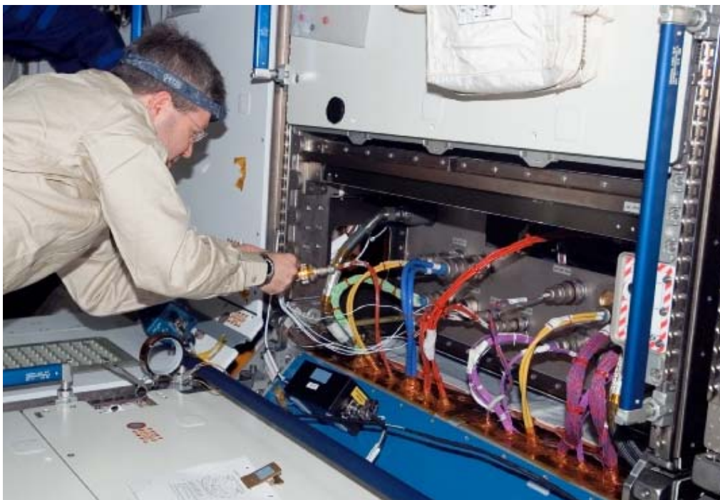
図3.3.4-12 ハーモニーの電力・通信配線のトラブルシュート (故障箇所の究明)
