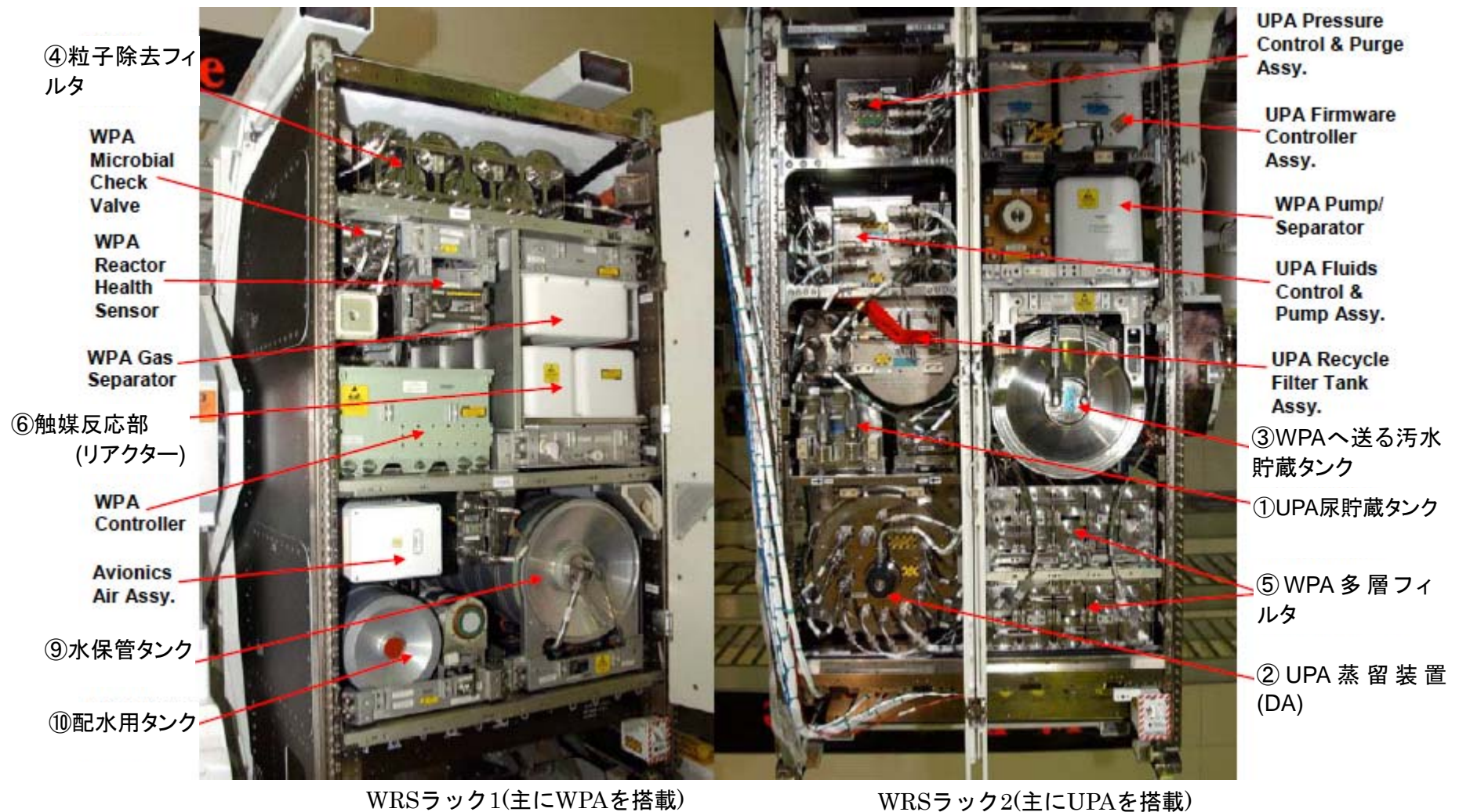
図3.4.1-1 WRS1, 2ラックの機器構成と水処理の主な流れ
