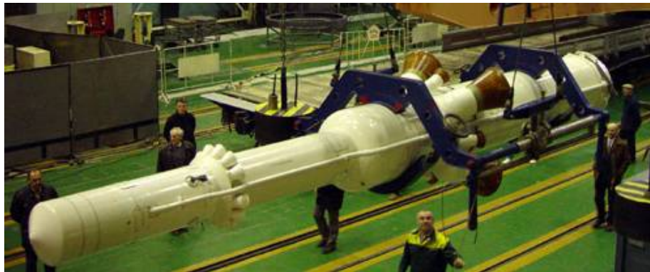
図2.1.6-4 ソユーズロケット先端に装着される緊急脱出用ロケット(RSCエネルギー社)
