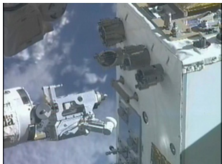
地上からのロボット操作で燃料補給に 必要な技術を検証する米国のRRM (Robotic Refueling Mission)
