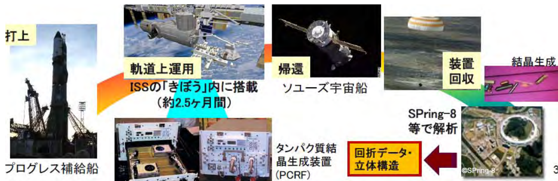
図1.4.1.1-7 JAXAのタンパク質結晶生成実験の流れ
