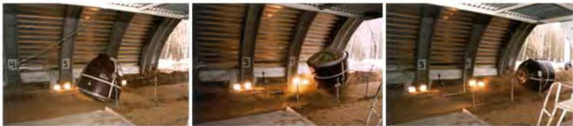
図2.1.5-1 ソユーズTMA帰還カプセルの落下衝撃試験の様子
