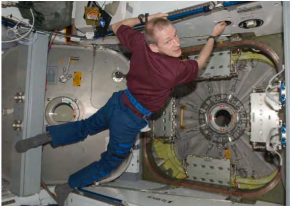
図1.6-11 共通結合機構(CBM)の2枚のハッチ(ISS側のハッチを開けた状態)
