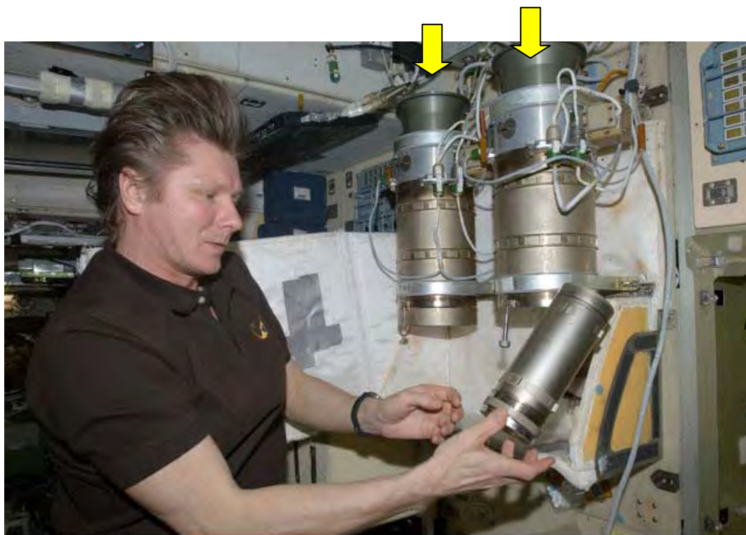
図3.4.2-2 ズヴェズダ内に設置されているSFOG容器2本（矢印）
