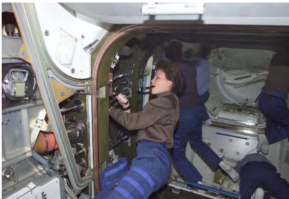
図3.3.4-9 米国のモジュール間での電力・通信・流体配管の接続作業
