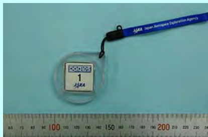
JAXAが開発したCrewPADLES(受動式線量計) これを常に携帯します
