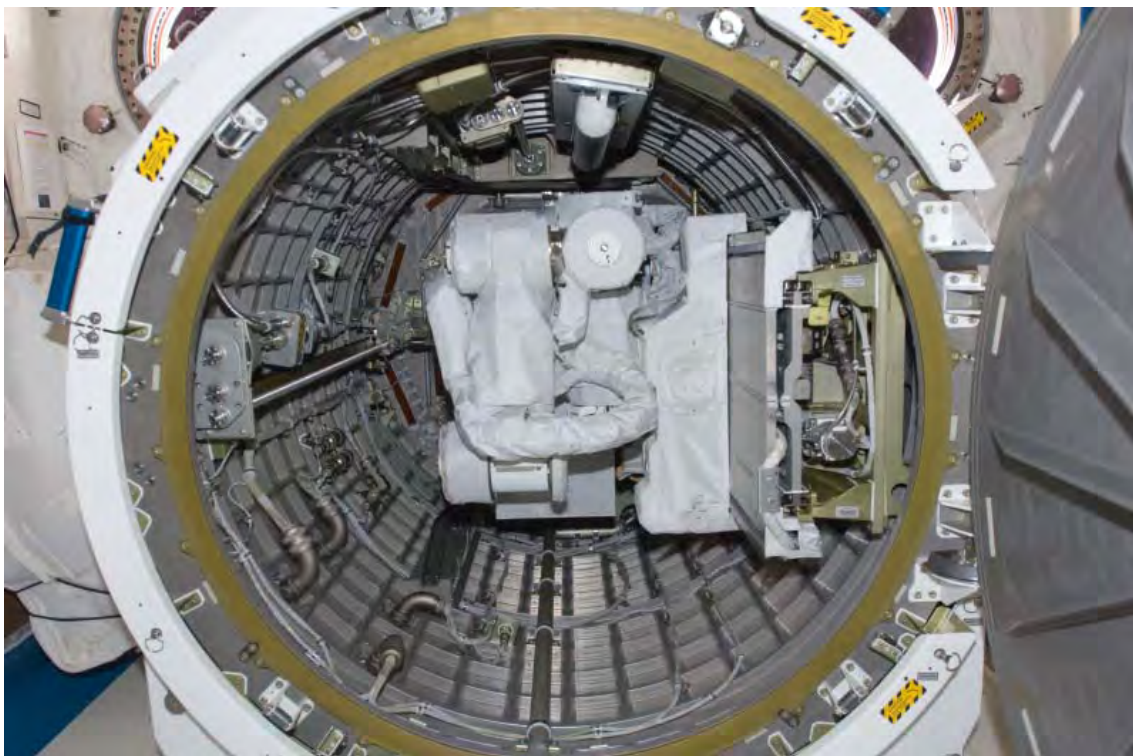
図 A2.1-4 子アームを船外へ出すためにエアロック内部を開けた状態(2010年3月)
