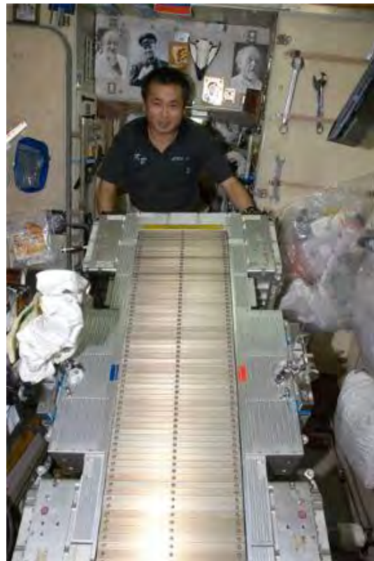
図1.4.2-3 水再生システムを点検する若田宇宙飛行士 (左)
