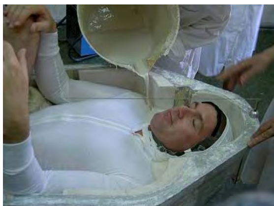
図2.1.6-9 シートライナーを石膏で型とりする様子
