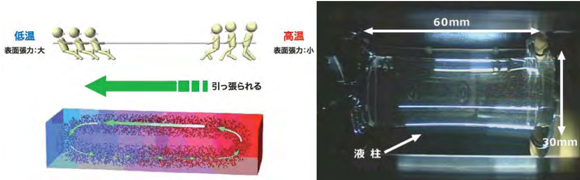
図1.4.1.1-2 マランゴニ対流の原理(左)と軌道上実験で作られた60mmの液柱(右)
