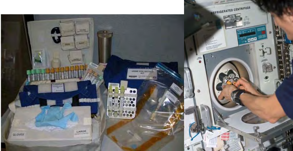
図1.4.1.2-3 Nutrition実験で使う採尿、採血キット(左)と、医学試料を扱えるISSの冷蔵遠心分離器(右) (NASA)
