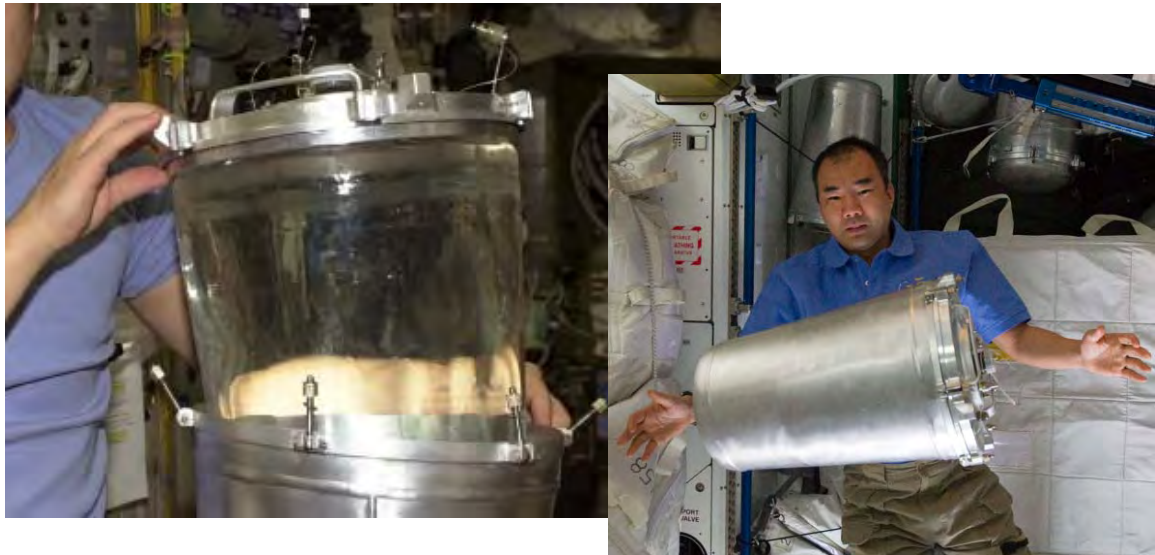
図3.4.1-5 ロシアの水容器(EDVタンク) (ビニールのような容器を金属容器で囲ったもの)
