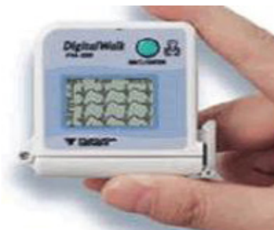
写真1:軌道上における心電計測に用いるホルター心電計
