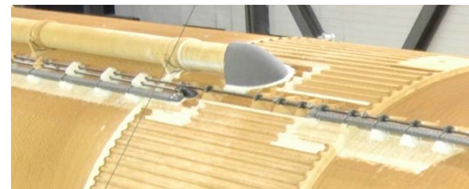
PALランプを除去したET (この断熱材は施工後は白色であり、紫外線に 曝されると褐色に変色する特徴を持つ)
