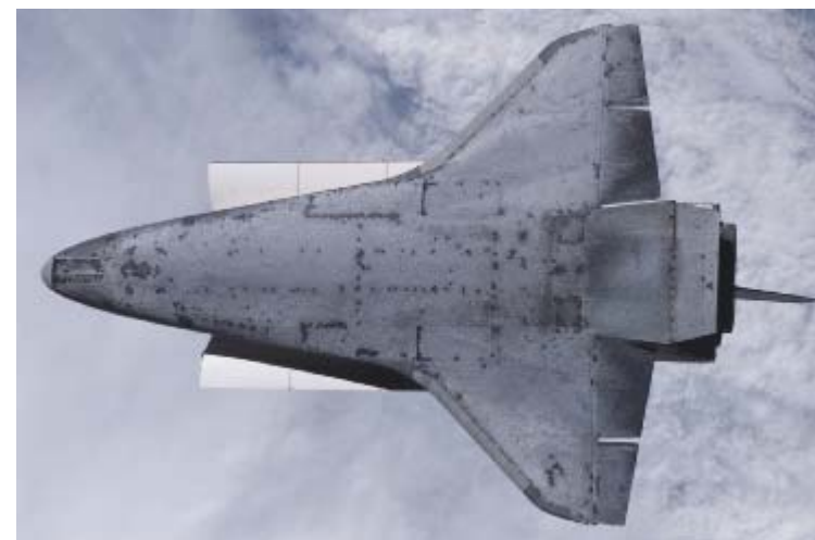
ISSからのスペースシャトルの熱防護システムの撮影
