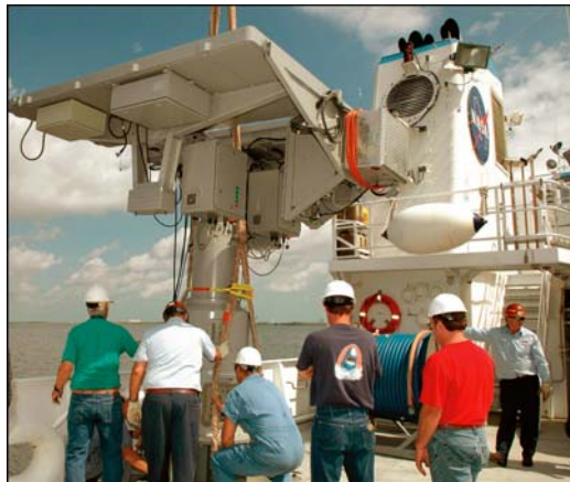
固体ロケットブースタ (SRB) 回収船に搭載 されたレーダ
