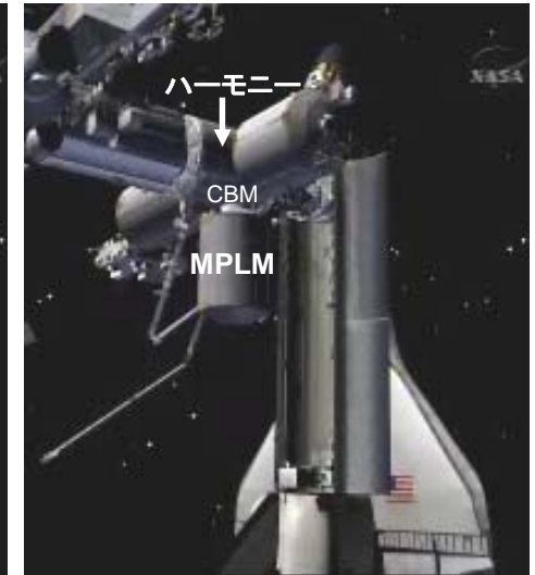
SSRMSでMPLMをハーモニー下側のCBMに取り付け(イメージ)
