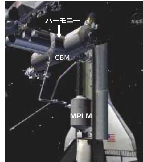
SSRMSでMPLMをハーモニー下側のCBMに取り付け(イメージ)
