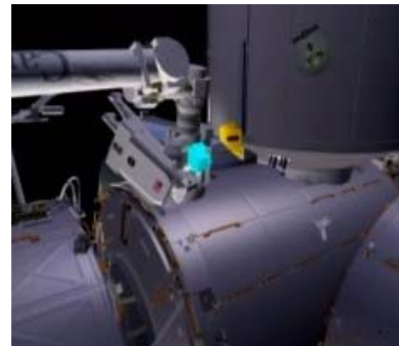
SSRMSカメラのレンズカバー(青い部分)取付けイメージ
