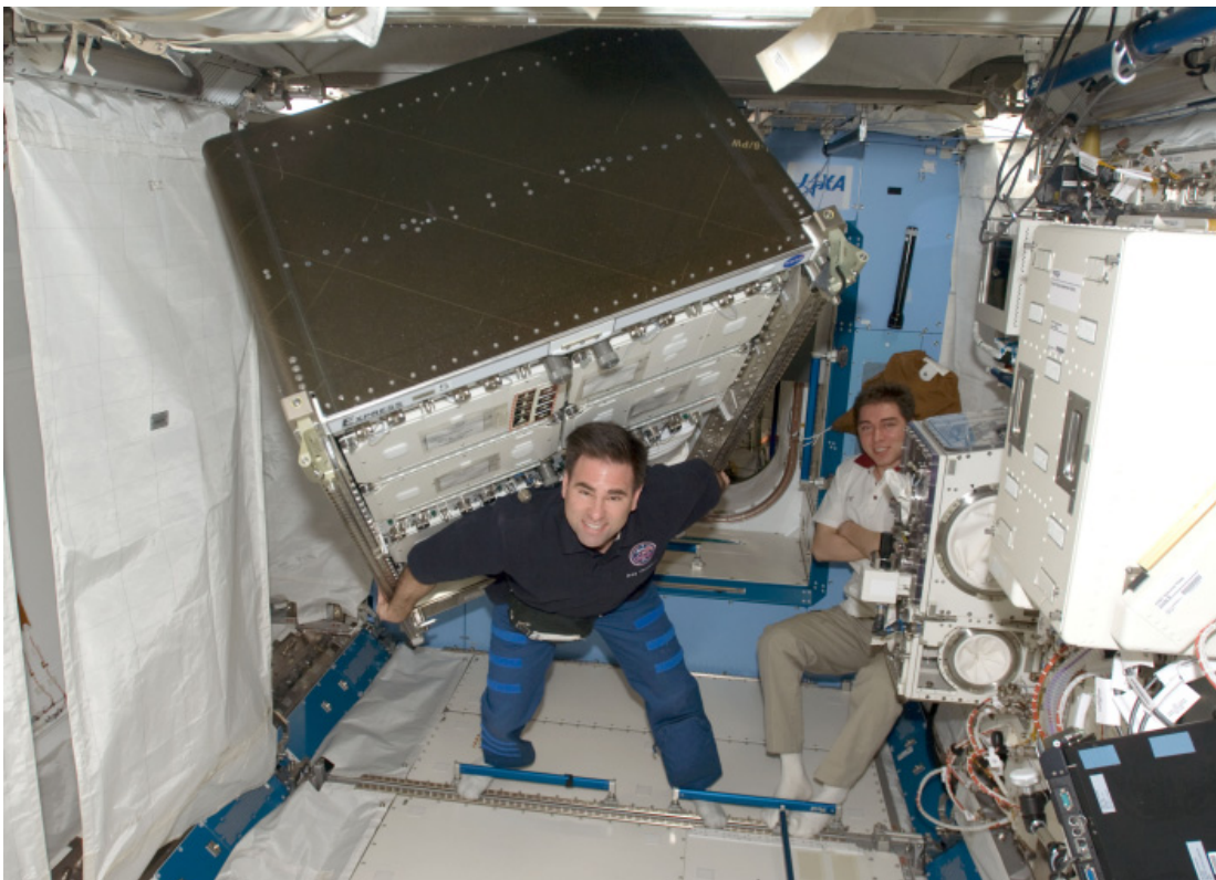
図4.3.4-13 きぼう内でのラックの搬入・設置作業（上・下）
