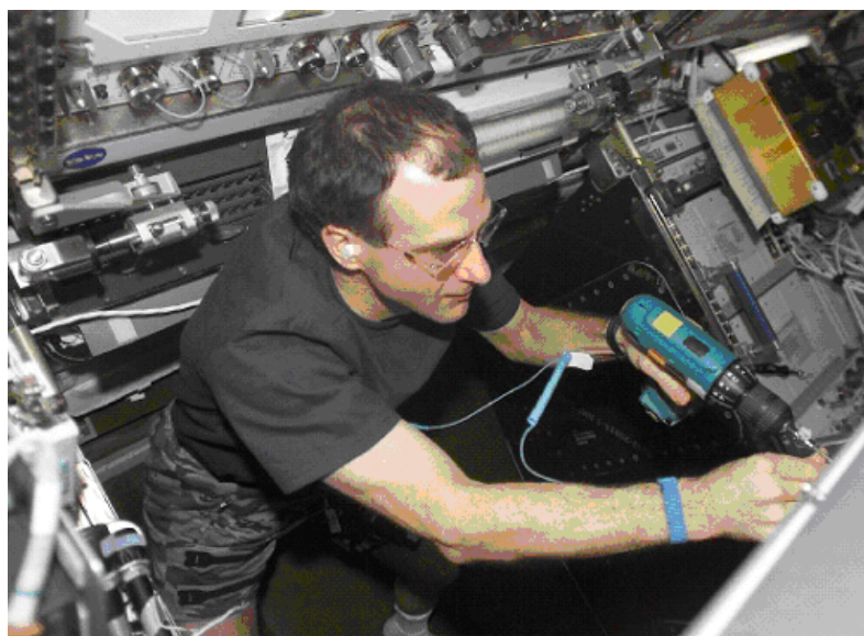
図4.3.4-1 パワーツールを使用した装置の分解
