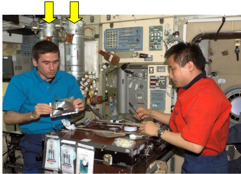
図4.4.2-2 ズヴェズダ内に設置されているSFOG容器2本（矢印）
