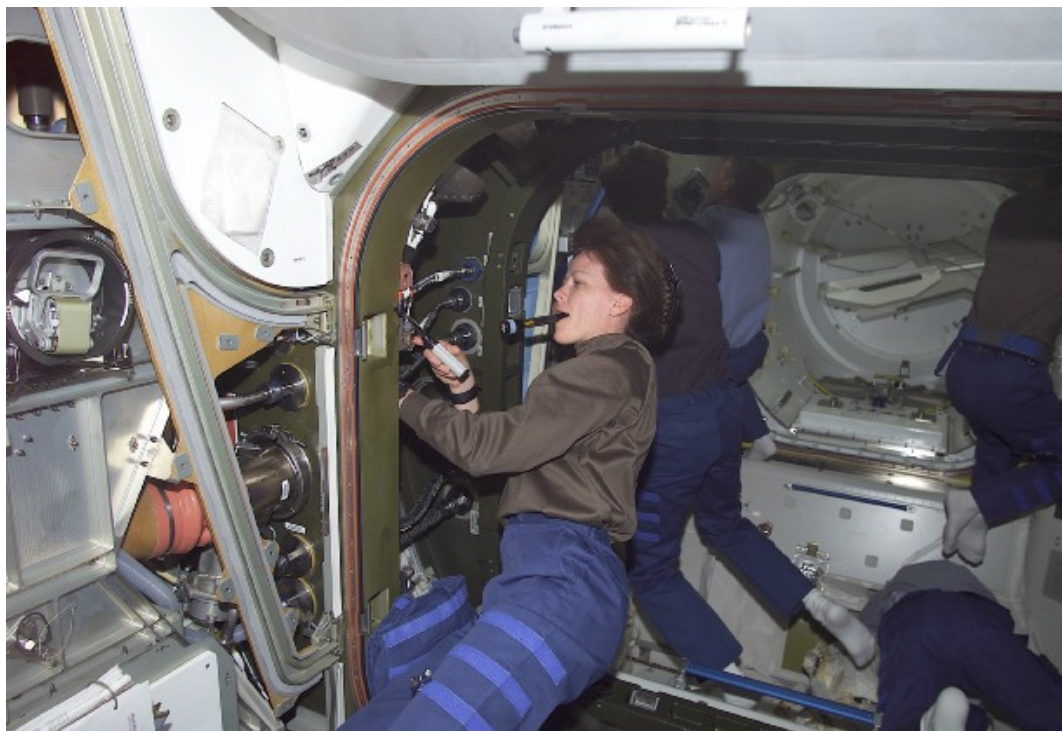
図4.3.4-9 米国のモジュール間での電力・通信・流体配管の接続作業
