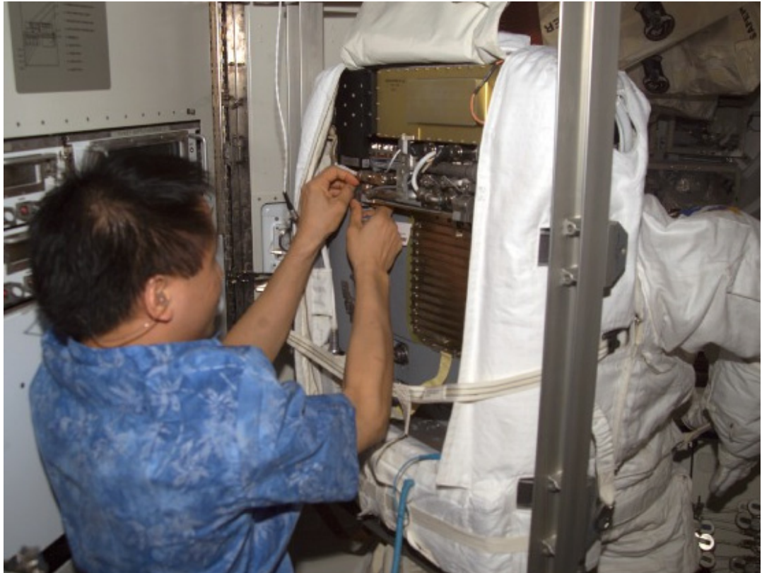
図4.3.4-16 米国の宇宙服の背中の機器のメンテナンス（定期保全）
