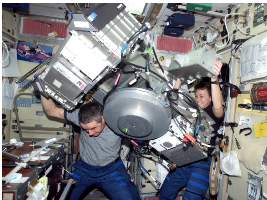
図4.3.4-2 TVISの修理（床下の機器を取り出した状態:2002年10月）
