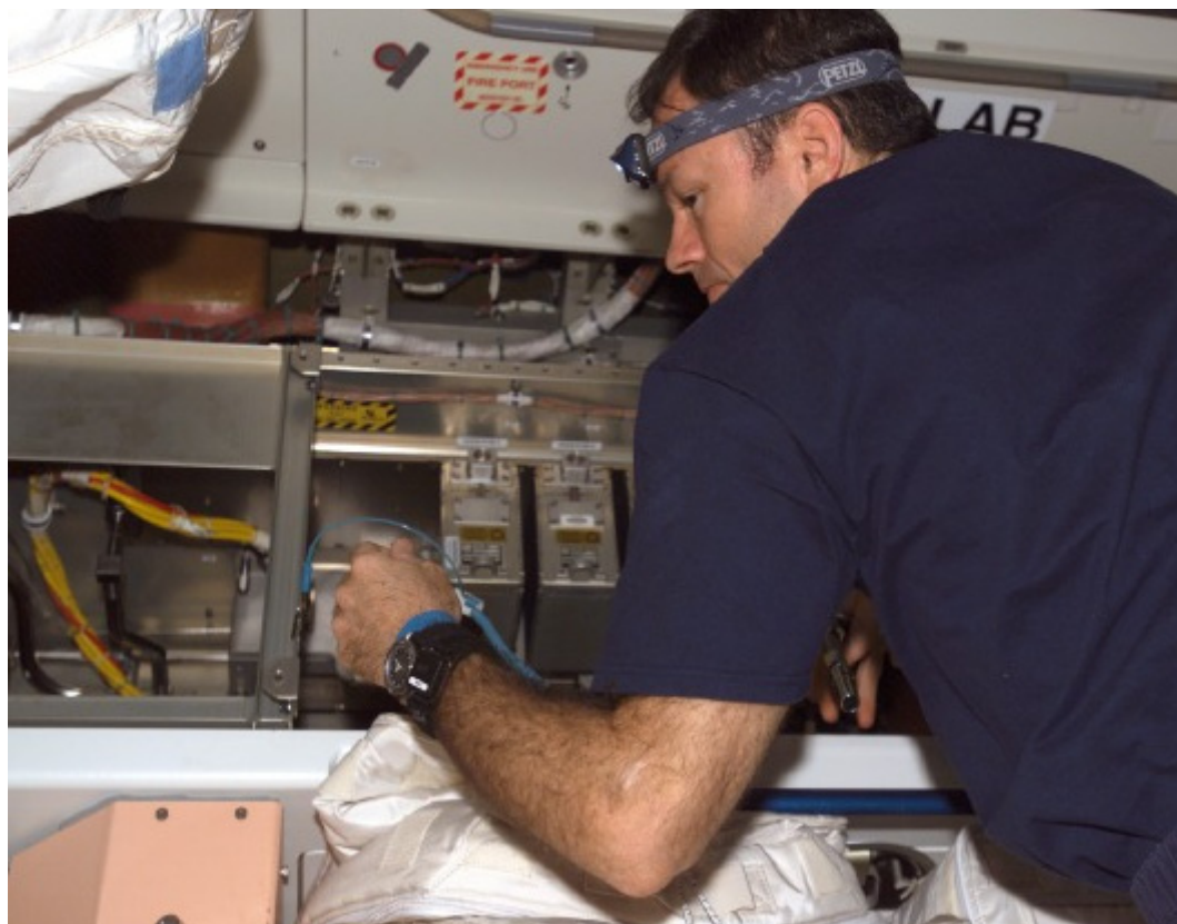
図4.3.4-4 遠隔電力制御モジュール(RPCM)の交換修理 (ユニティ内)
