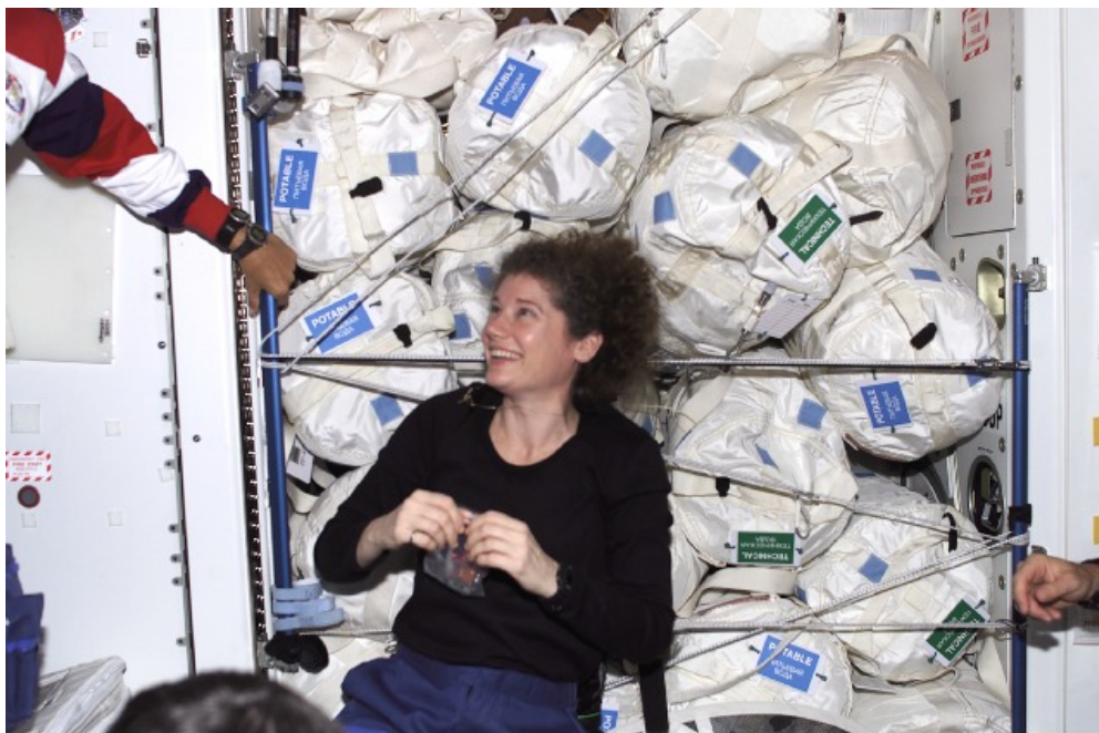
図4.4.1-6 米国の水容器(CWC) (表面が布地のソフトタイプの容器)
