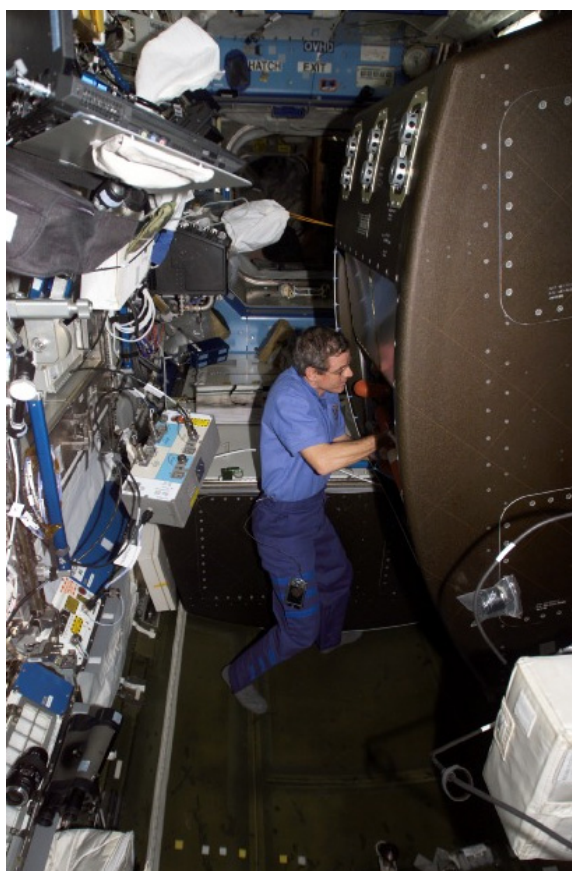
図4.3.4-15 ラック背面からアクセスする機器修理・調整作業
