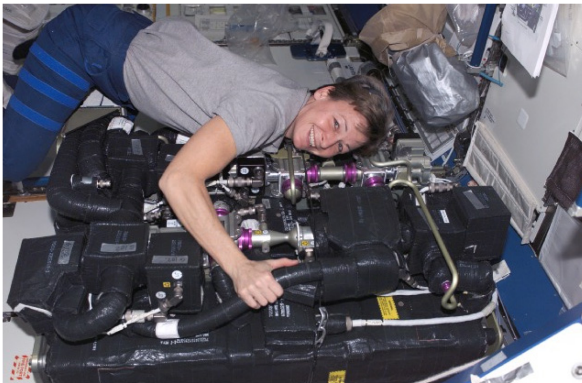
図4.3.4-3 米国の二酸化炭素除去装置(CDRA)の修理 (デスティニー内)
