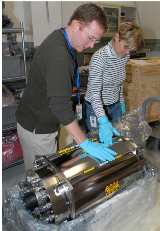
図4.4.1-4 STS-119で運ばれる交換用のDistillation Assembly(DA)
