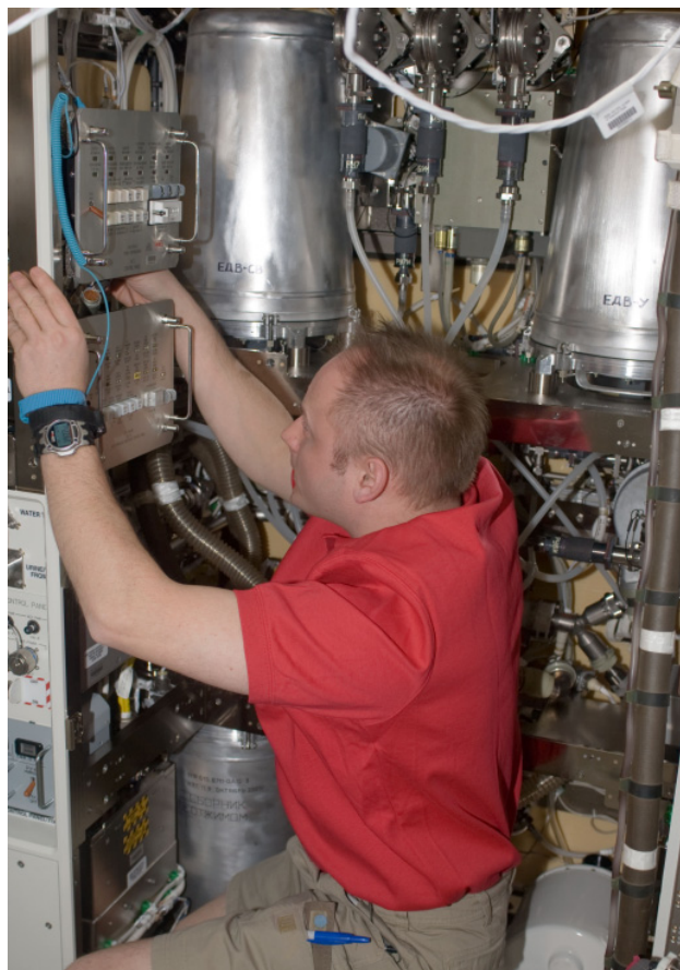
図4.3.4-6 米国のトイレ(WHC)の内部機器の組立作業
