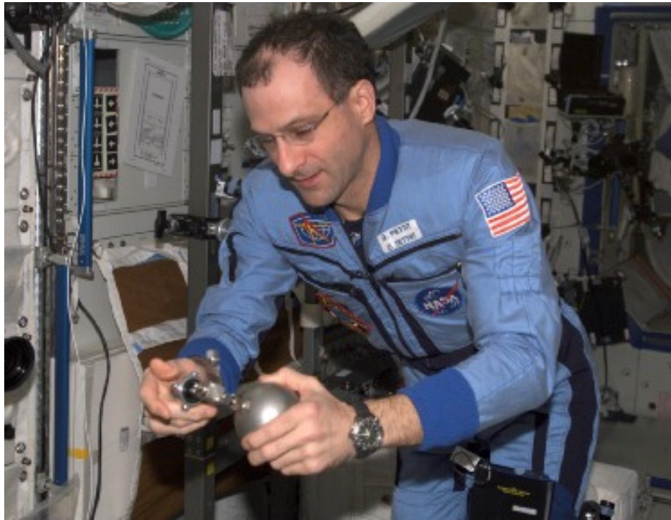
図4.3.3-6 ISS内での空気サンプルの採取作業(回収して地上で分析)
