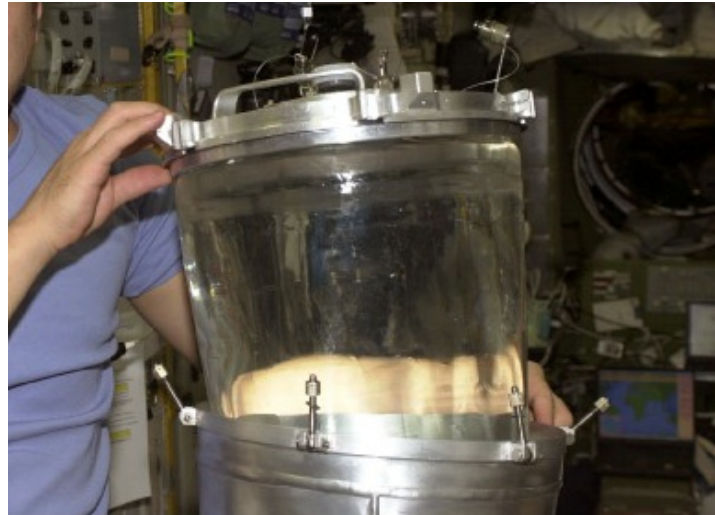
図4.4.1-5 ロシアの水容器(EDVタンク) (ビニールのような容器を金属容器で囲ったもの)
