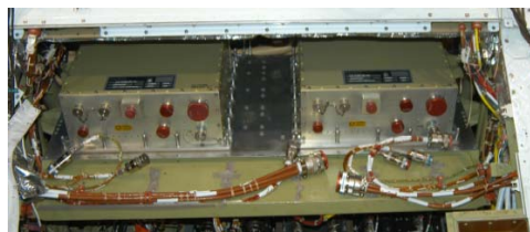
カーゴベイの下に新たに装備された2基のPTU (Power Transfer Unit)
