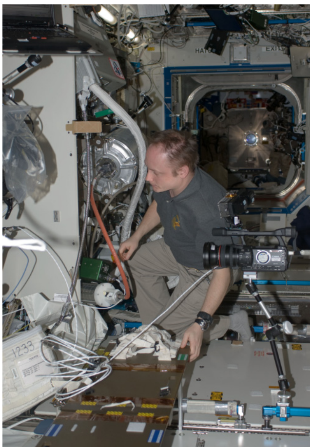
図4.3.4-10 水再生システム(WRS)ラック 尿処理装置のトラブル対応作業
