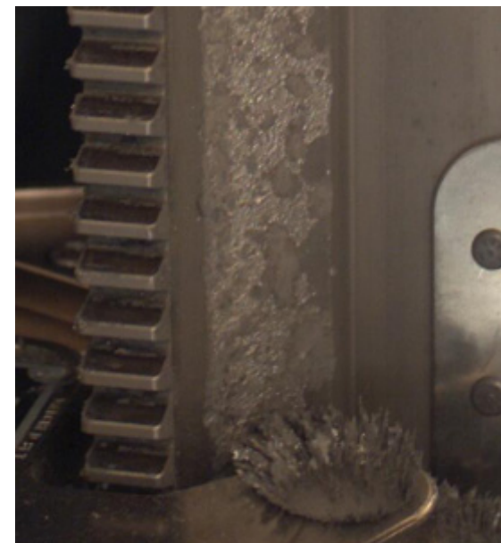
SARJ表面の損傷状況
