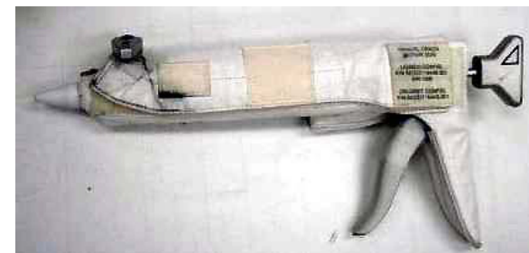
EVAで使用する潤滑用のグリースガン (Braycoat Grease Gun) (STS-126プ レスキット)
