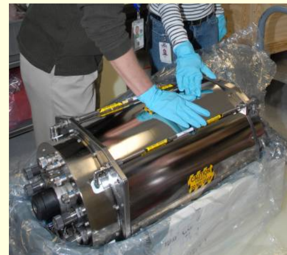
STS-119で運んで交換を行う尿処理装置(UPA)の蒸留装置(DA)
