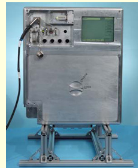
有機炭素分析器 (Total Organic Carbon Analyzer: TOCA II) (NASA STS-126プレスキット)
