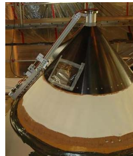
ET上部のスプレー吹き付け修理部
