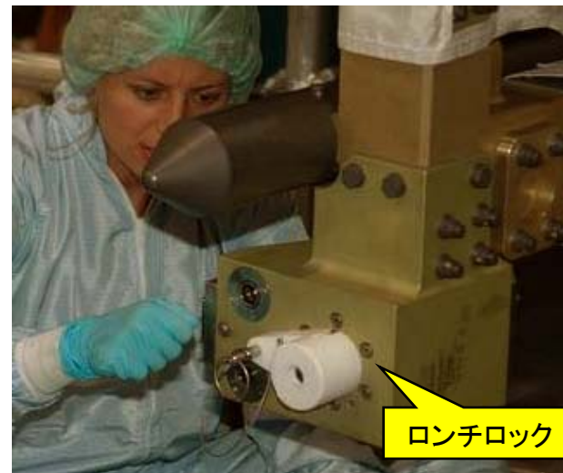
S5トラスのS4トラスとの結合部(拡大)とロンチロック
