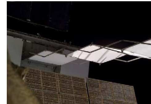
S1トラスのラジエータ展開 (STS-112ミッション)
