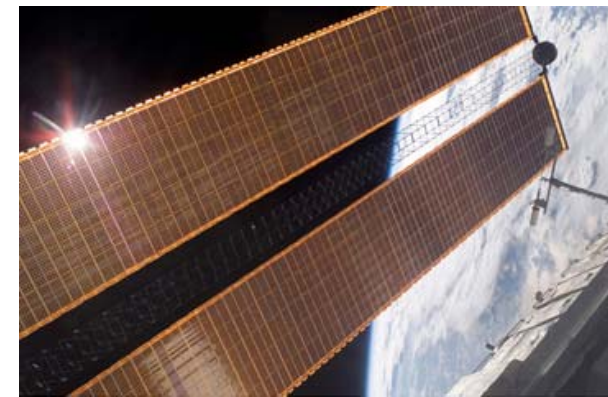
P4トラスの太陽電池パドル展開 (STS-115ミッション)
