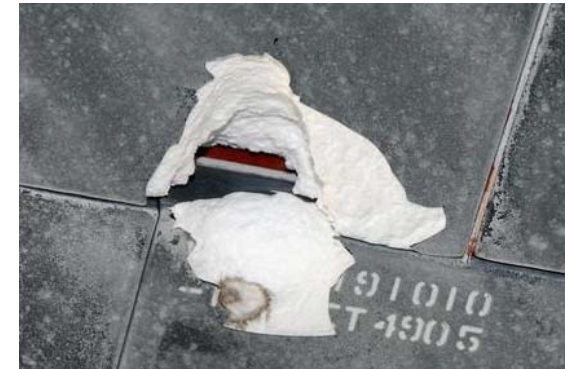
STS-118ミッションで支持ブラケットの断熱材が衝突して損傷したタイル(帰還後に撮影)
