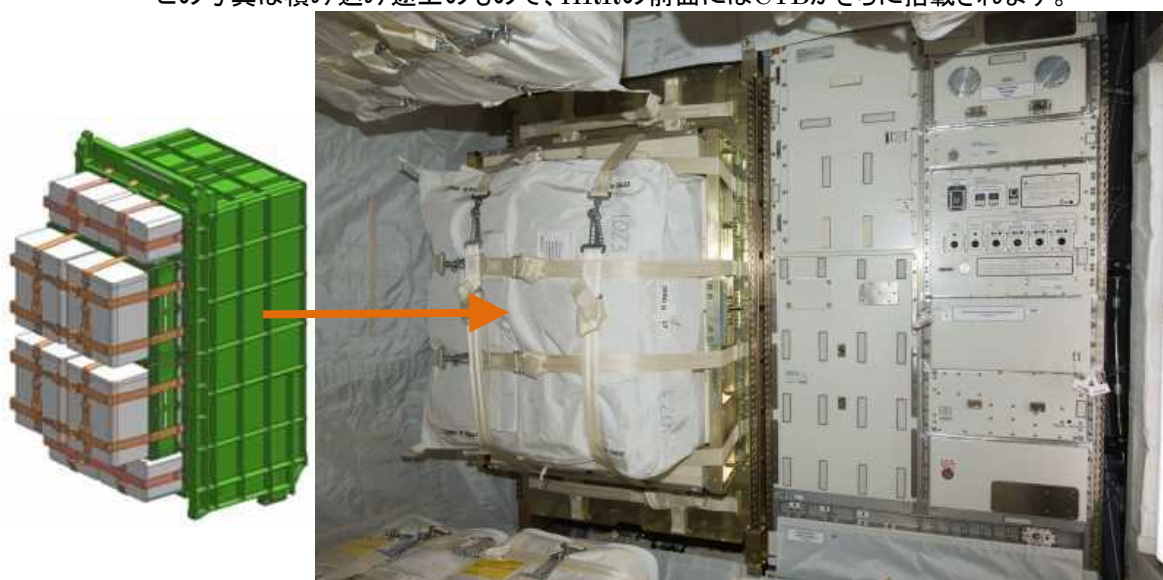
図4.1-4 ラック前面へ搭載された物資輸送用バッグ(CTB)の例 (HTV2) (右側は温度勾配炉(KOBAYASHI)ラック)
