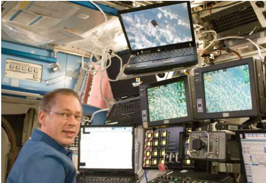
HTVを把持する際に使われるロボットアーム操作卓(HTV1) (NASA提供)
