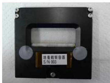
AnisoTubuleチャンバー(種子をセットした蛍光顕微鏡用容器)
