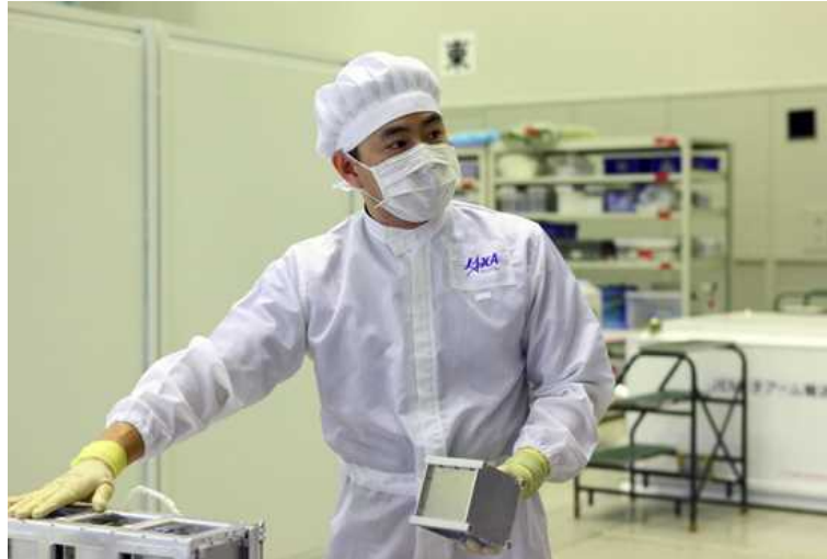
図 A4-9 CubeSat(星出宇宙飛行士が手に持っているのが1UサイズのCubeSat) (提供 JAXA)
