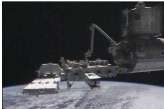
船外プラットフォーム先端に仮置きされた曝露パレット(HTV1)
