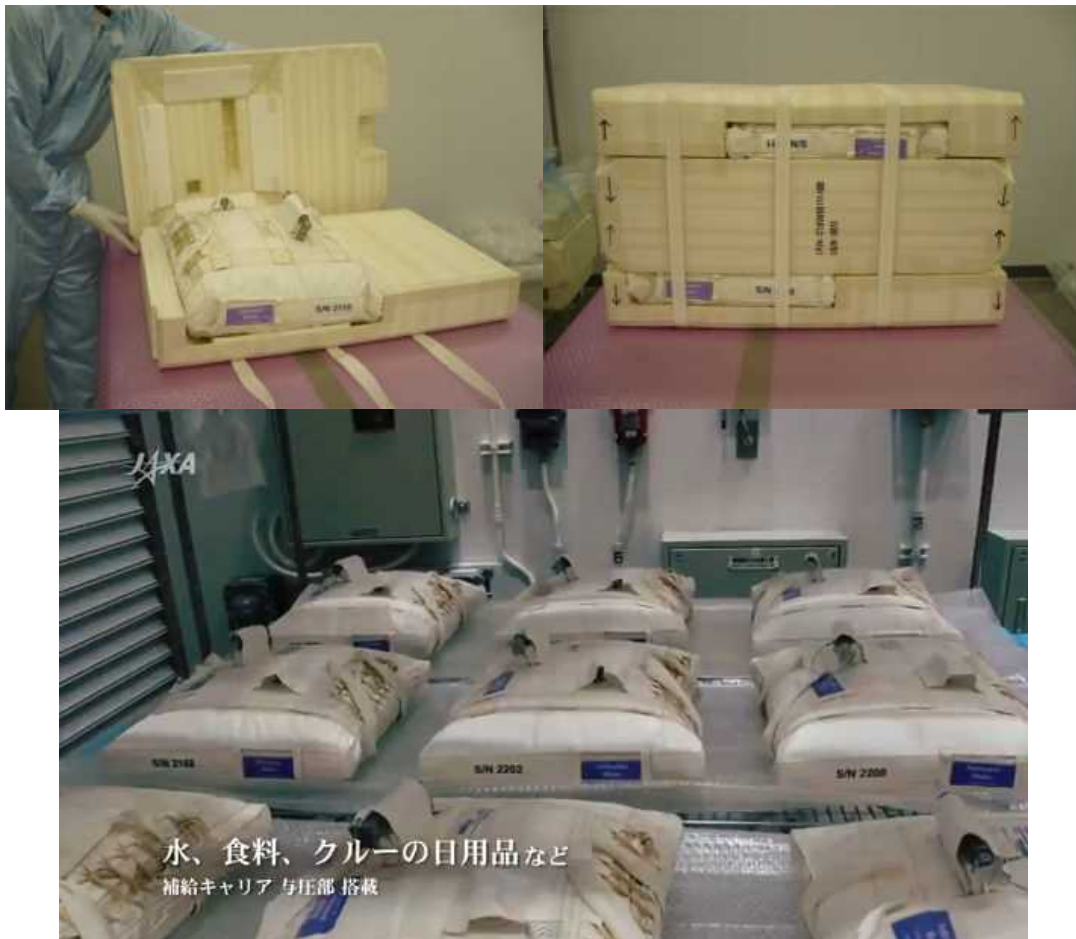
図A3-2 飲料水を充填した水バッグ(CWC-I)と梱包材(上:HTV2、下:HTV4) (上の写真で紫色のラベルがつけられた袋が水バッグで、周りは梱包材です)
