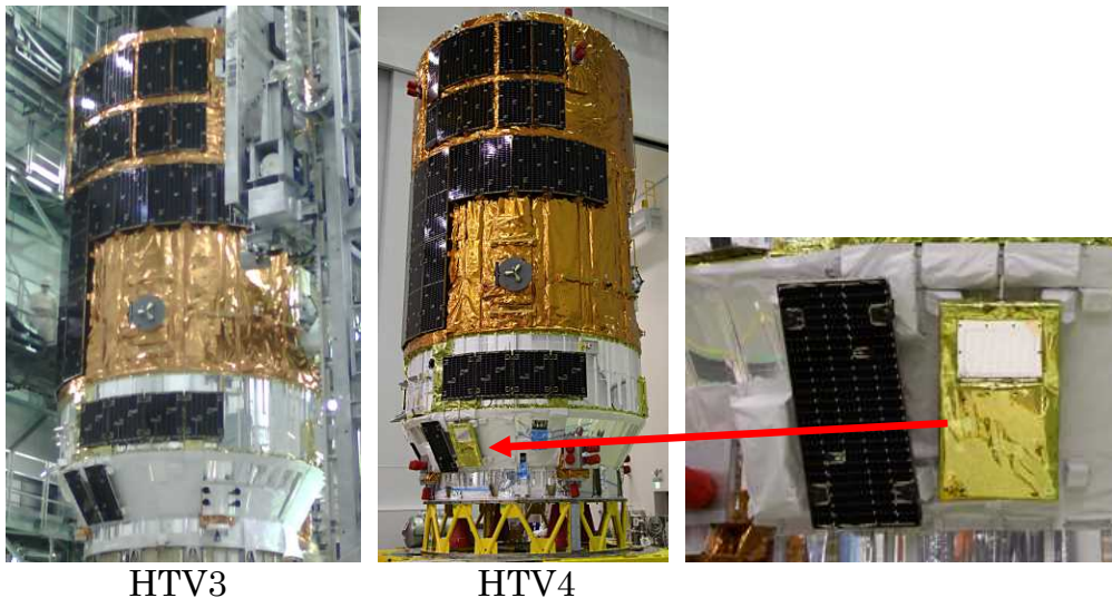
図5.2-1 表面電位センサ(ATOTIE-mini)の設置場所
