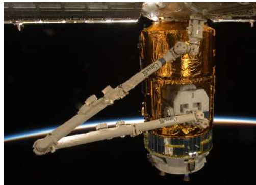
ISSのロボットアームで、曝露パレットをHTV補給キャリア非与圧部から取り出す写真
