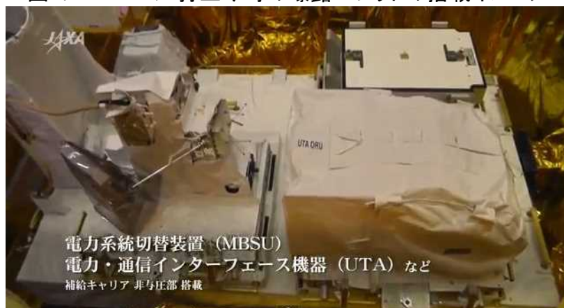
図4.2-3 HTV4の曝露パレットに搭載された船外物資
