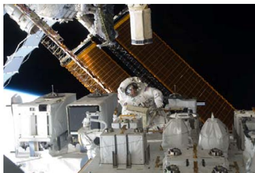
【参考】船外実験プラットフォームに船外パレットが取り付けられている状態 (STS-127ミッション)
