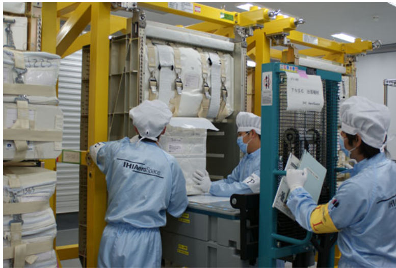
図2.3.1-3 HTV補給ラック(HRR)に搭載される物資輸送用バッグ(CTB)
