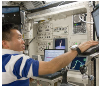
「きぼう」ロボットアームの制御ラック
