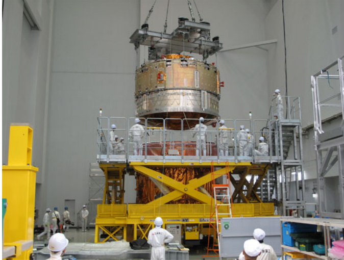
図1.3.1-3 HTV補給キャリア与圧部と補給キャリア非与圧部の結合
