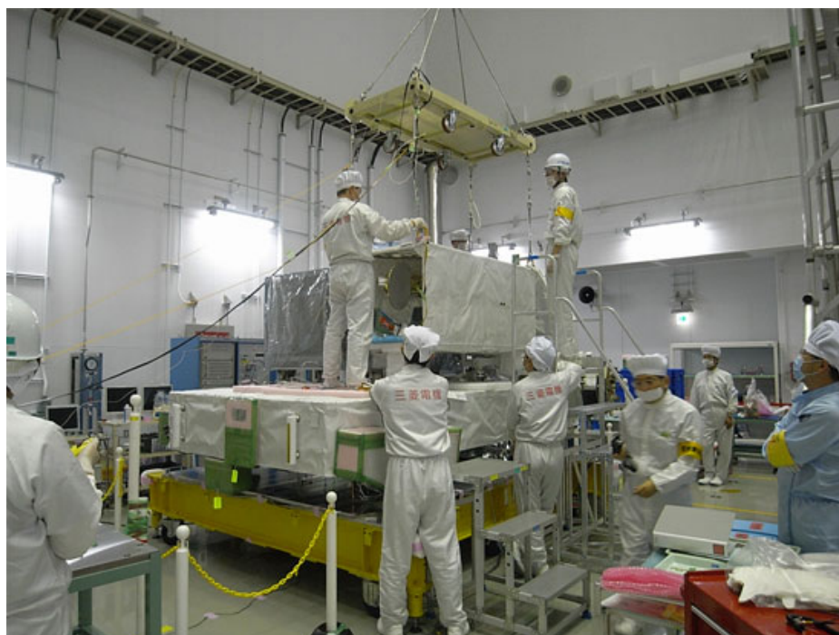
図2.3-2 HTV曝露パレット(船外実験装置の搭載作業)
