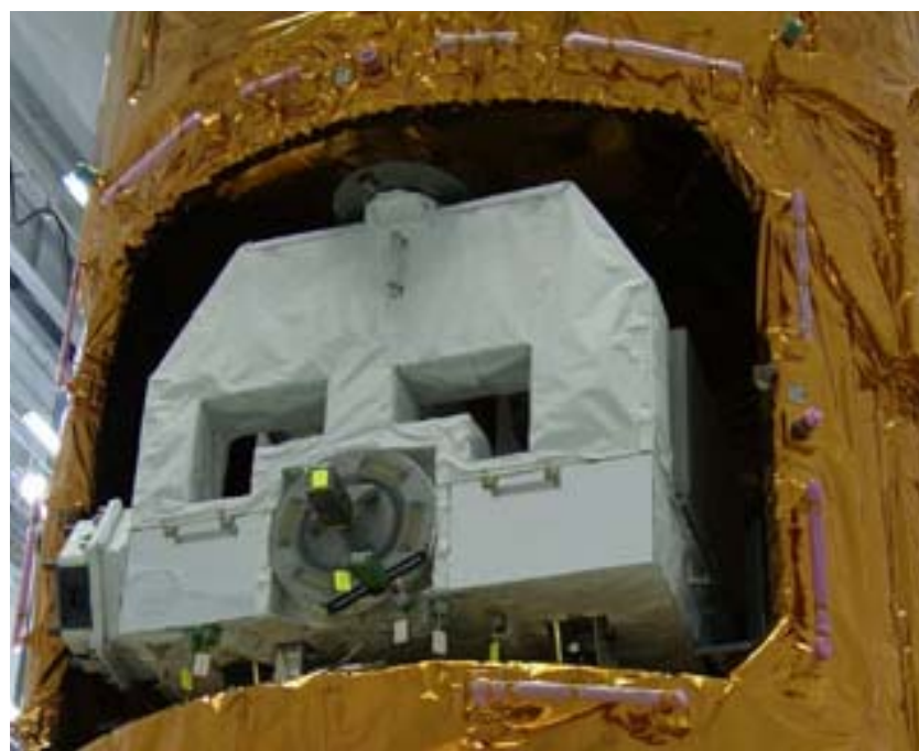
図1.2.3-2 補給キャリア非与圧部に搭載された曝露パレット
