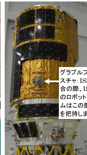
図1.2.2-5 補給キャリア非与圧部のグラブルフィクスチャ(HTV初号機)
