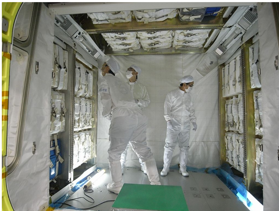
図2.3-1 HTV補給キャリア与圧部(補給物資が搭載された状態)
