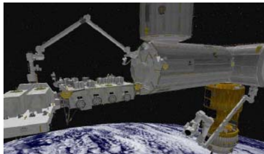
曝露パレットはISSのロボットアームから、「きぼう」ロボットアームに受け渡され、「きぼう」のロボットアームで船外実験プラットフォームに取り付けられます。
