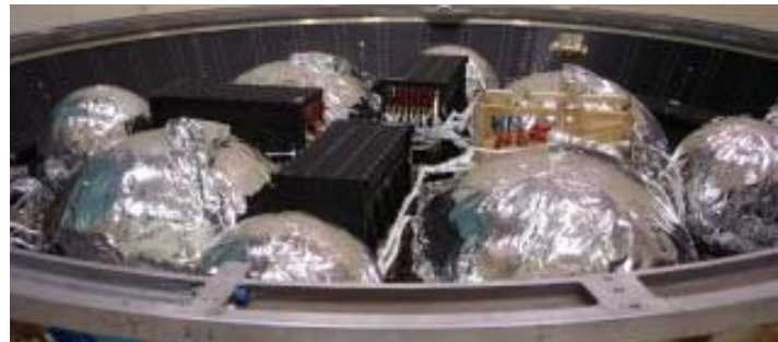
図1.2.5-2 推進モジュールの推進剤タンク 拡大図
