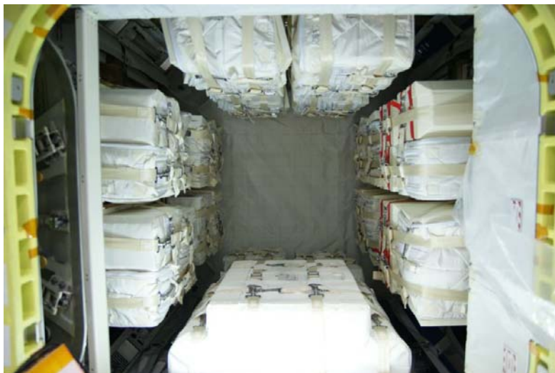
図2.3.1-5 HTV補給ラック(HRR)のPLCへの搭載状況 *HRRの前面にもCTBが搭載されます。
