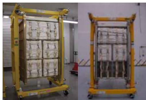
左:HTV補給ラック(HRR) 右「きぼう」保管ラック(PSRR)
