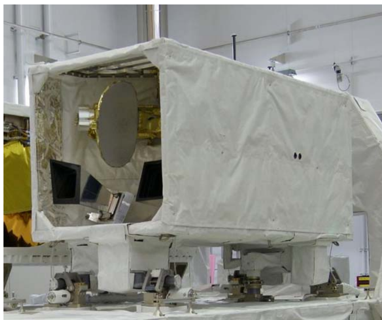
図2.3.2-1 曝露パレットに搭載されるSMILES
