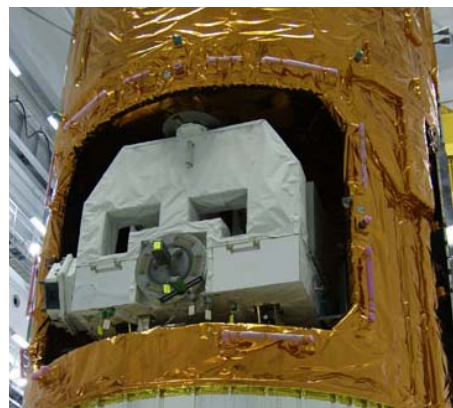
図1.2.2-3 曝露パレットを搭載 した状態(HTV初号機)
