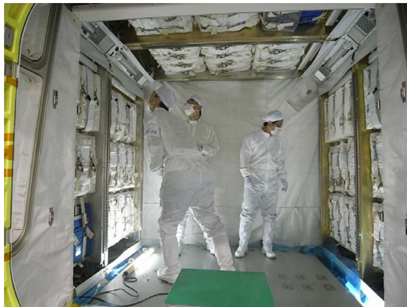
図1.2.1-2 補給キャリア与圧部の内部(HTV初号機)
