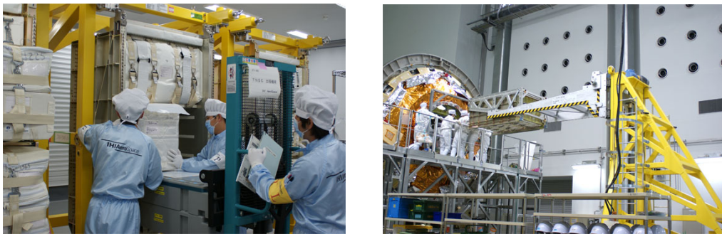
図1.3.1-1 HTV補給ラックに搭載される物資輸送用バッグ(左)と補給キャリア与圧部に搭載されるHTV補給ラック
