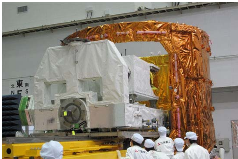
図1.3.1-2 補給キャリア非与圧部に搭載される曝露パレット
