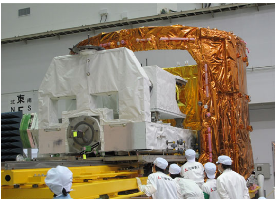
図1.2.2-2 曝露パレットが搭載される ところ(HTV初号機)
