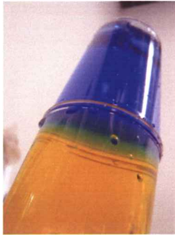
写真5 プラスチックシートをはさみ、塩酸(下)の上に水酸化ナトリウム水溶液(上)をのせたもの
