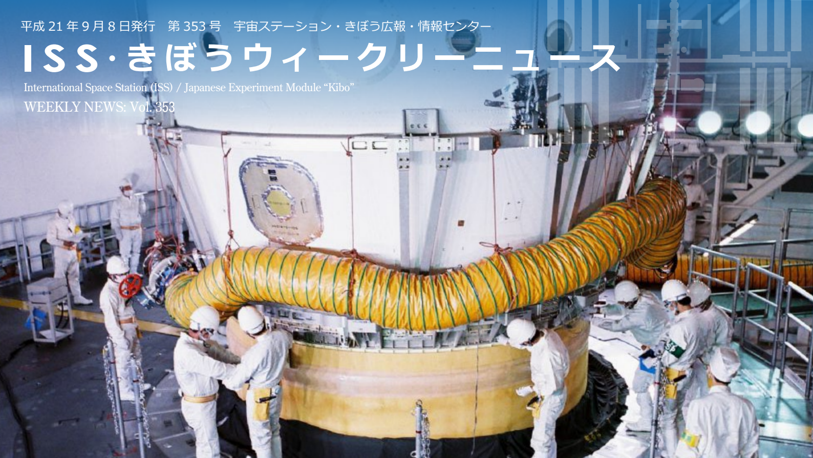
宇宙ステーション補給機 (HTV) 技術実証機 (初号機) が格納された衛星フェアリングと H-IIIB 第 2 段ロケットの結合
