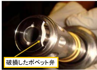
FCVの破損したポペット弁の様子 (STS-126) (提供: NASA)
