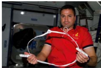
第4回船外活動で太陽電池パドルの破損箇所に取り付ける補修材を持つジョージ・ザムカ宇宙飛行士(飛行10日目)
