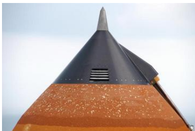
雹による断熱材損傷の状況(白い点々が損傷箇所)
