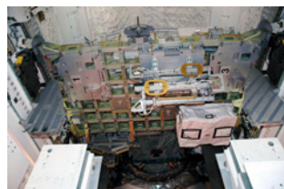
ディスカバリー号のペイロードベイに搭載された船外保管プラットフォーム2(ESP-2)
