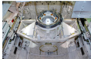
ディスカバリー号のペイロードベイに設置されたISSとのドッキングシステム(ODS)
