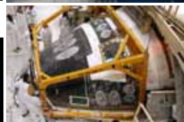
ディスカバリー号への前部姿勢制御システム(FRCS)の取り付け作業
