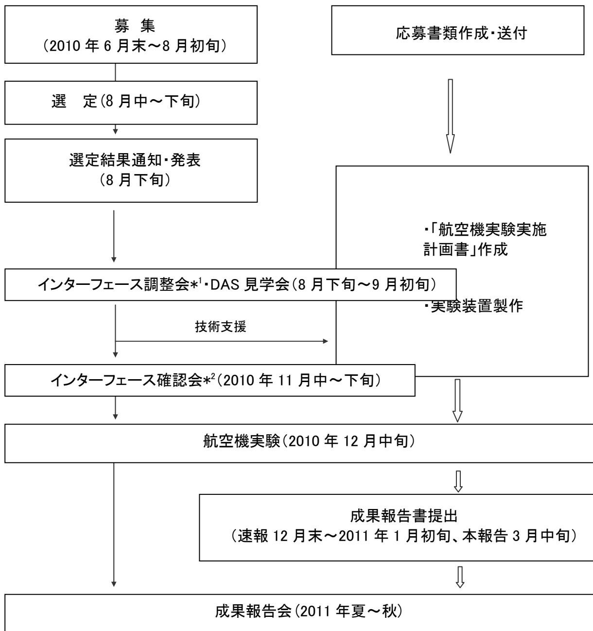
\*1 インターフェース調整会：実験装置に航空機の制約（実験スペース、電源、電磁干渉等）を反映させ、航空機実験に適した装置にするために行う。
