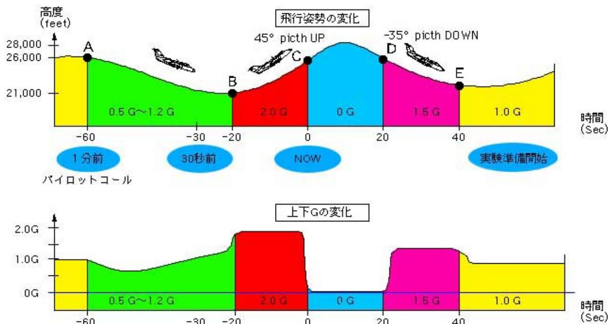
放物線飛行、パラボリックフライトと呼んでいるこの飛行方法では、その開始点である上図のC点（ボールを投げ出す点）において、大きな速度と上昇角を得たいので、B点において航空機の最大速度に加速しておき、C点までに急激に機首を引き上げます。このためB点～C点間は2G（通常の2倍の重力）がかかります。C点からは放物線を描くように航空機をコントロールします。このまま放物線飛行を続けると上昇の頂点を経て落下加速運動に入り最後には航空機の制限速度をオーバーしてしまいます。このため安全に回復可能な（機首下げ角が35°～40°）D点で放物線飛行を終了させます。この間、C～D点間で機内に無重力環境ができるのです。C～D点間の時間は航空機の性能によって変わりますが、通常の民間ジェット機クラスで約20秒間、プロペラ機では約10秒、音速を超える戦闘機では40秒程度になります。
