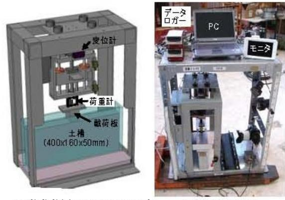
(a) 載荷装置のCADイメージ
