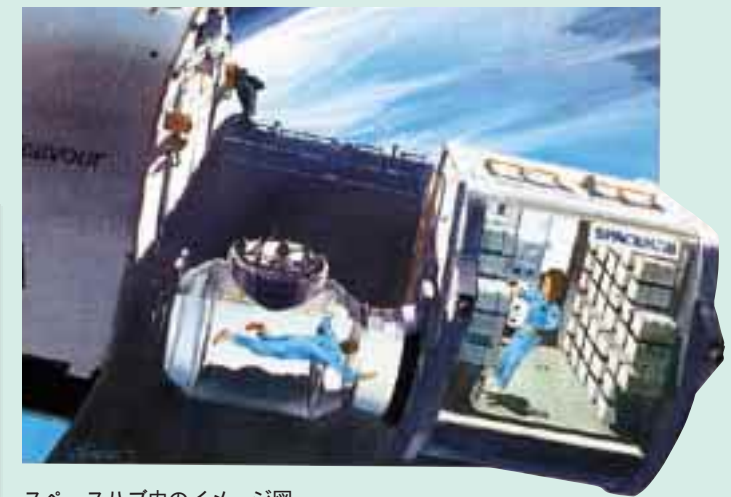
スペースハブ内のイメージ図 壁面に取り付けられた小さな箱がロッカーです。奥にはラックが取り付けられています。
