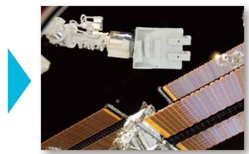
4 「きぼう」のロボットアームでJ-SSODの親アーム先端取付型実験プラットフォームを把持し、衛星放出ポイントまで移動。
