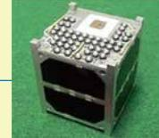
超小型衛星では初めてマイクロ波による高速通信実験に成功し、放出行時に撮影したISSや地表の画像の地球へ転送した。世界で初めてLEDで衛星を人工星として光らせ、モールス信号でメッセージを地上に届けた。
