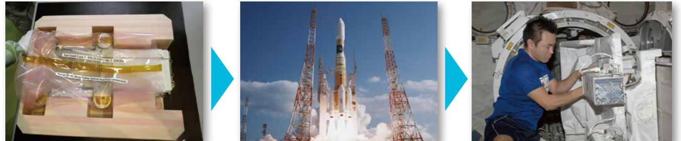
1 小型衛星を搭載した衛星搭載ケースを、船内貨物の輸送用ソフトバッグ CTBに収納。
