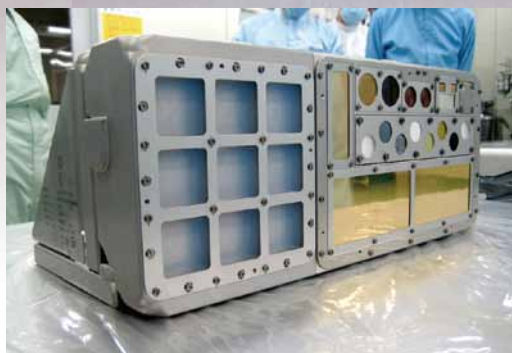
「きぼう」の宇宙環境計測ミッション装置 (SEDA-AP) に搭載された 「微粒子捕獲実験 (MPAC)」と「材料曝露実験 (SEED)」
