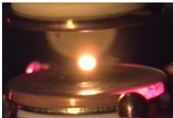
図1 地上静電浮遊炉での浮遊と加熱
