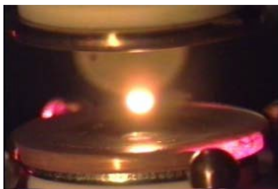
図 1 地上静電浮遊炉での浮遊と加熱
