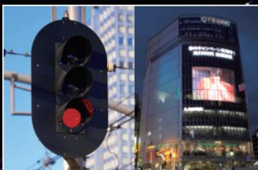
発光ダイオードは電流を流すと光を出す半導体素子のことです。効率が良く耐久年数も長いため、最近では信号機に発光ダイオードが使われる割合が多くなっています。さらに街中の大型ディスプレイや電車の行き先表示板など、化合物半導体素子が生活の中に浸透つつあります。ナノテンプレート実験は、身近なところへの大きな貢献が期待できます。
