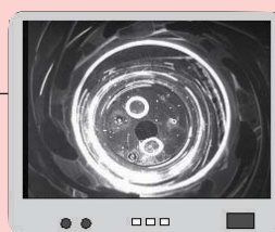
3次元流速計測 3台のカメラで対流の様子を 3次的に捉える
