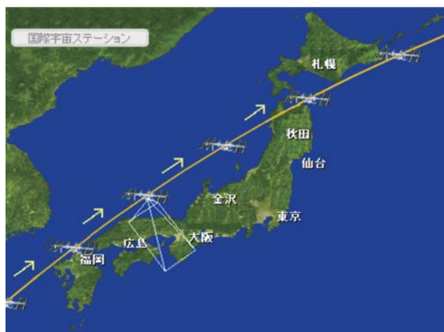
図4 日本列島撮影予想イメージ 縦200km×横350kmの地表範囲を撮影しながら日本列島を通過
