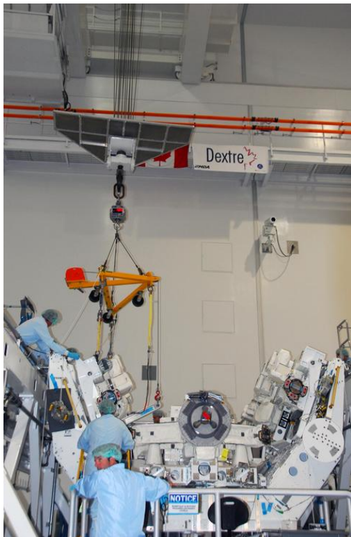
SLP-D1 にデクスターを搭載しているところ (NASA ケネディ宇宙センター(KSC) 宇宙ステーション整備施設)
