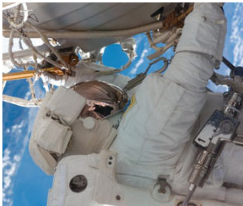
ORU を船外保管プラットフォームに取り付ける様子(STS-120)
