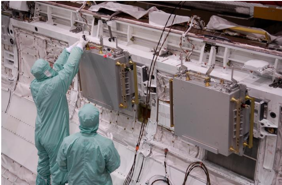
材料曝露実験装置 6(Materials ISS Experiment: MISSE-6) エンデバー号のペイロードベイ(貨物室)に搭載された様子 (NASA ケネディ宇宙センター(KSC) オービタ整備棟)
