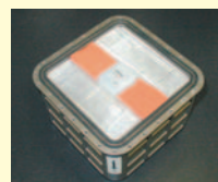
グラナダ結晶生成装置 (サイズ:134×134×84mm) Granada Crystallization Facility (Dimensions:134×134×84mm)
