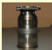
JAXA結晶生成装置 (サイズ:φ90×165mm) JAXA Crystallization Facility (Dimensions:φ90×165mm)
