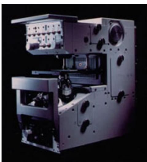
クリーンベンチは内部に倒立位相差・蛍光顕微鏡を持っています。顕微鏡は普通の光学顕微鏡のほか、位相差フィルタ(内蔵)を使えば、位相差顕微鏡に、蛍光フィルタ(交換可)を使えば、蛍光顕微鏡として使えます。対物レンズ倍率は  $\times 4$ 、 $\times 10$ 、 $\times 20$ 、 $\times 40$  が準備されています。
