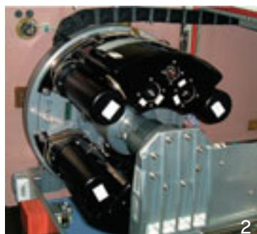
1 観察のためレーザを照射中の様子 2 CBEFのターンテーブルに装着
